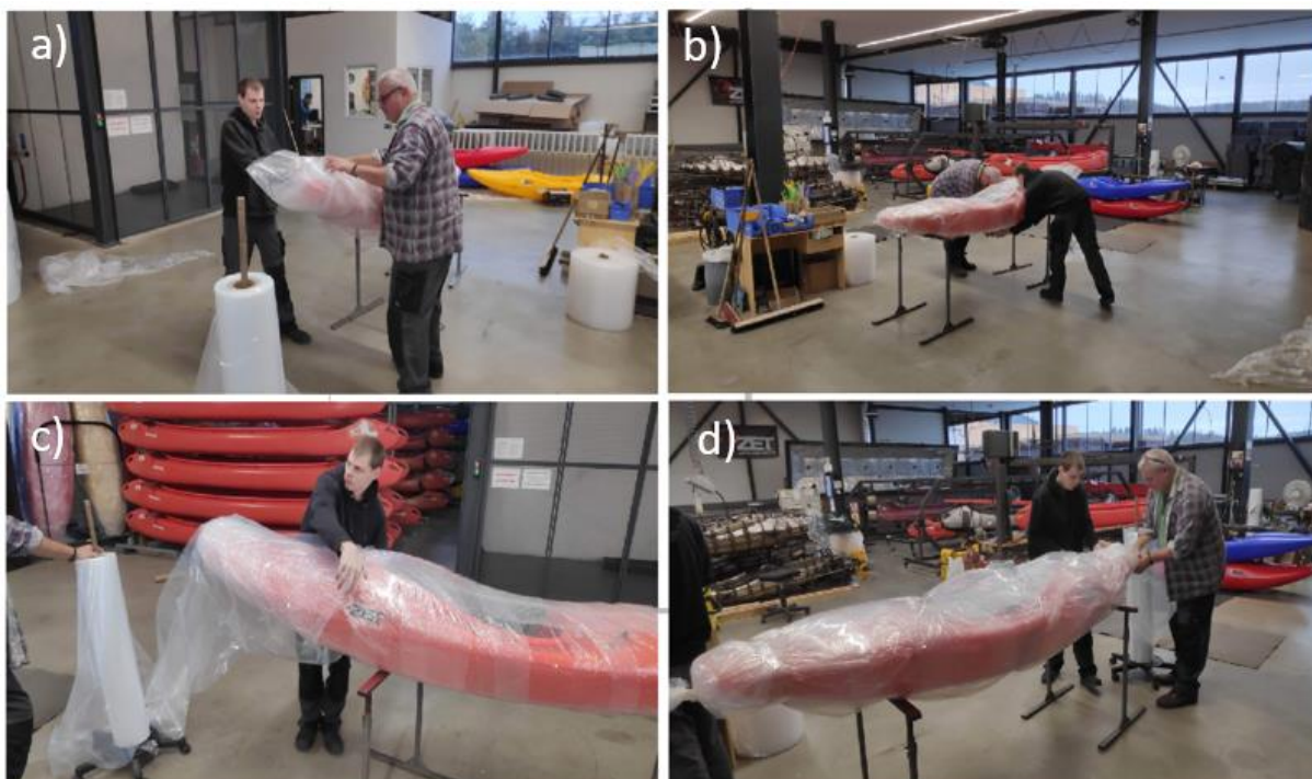
Obr. 4.5 – Proces balení. a) bublinková fólie b) stretch fólie c) polyetylénový rukáv d) lepicí páska
