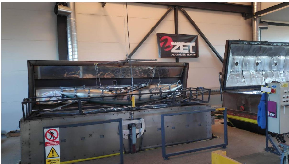
Obr. 4.2 – Vyjímání formy z pece za pomoci stropního jeřábu.
