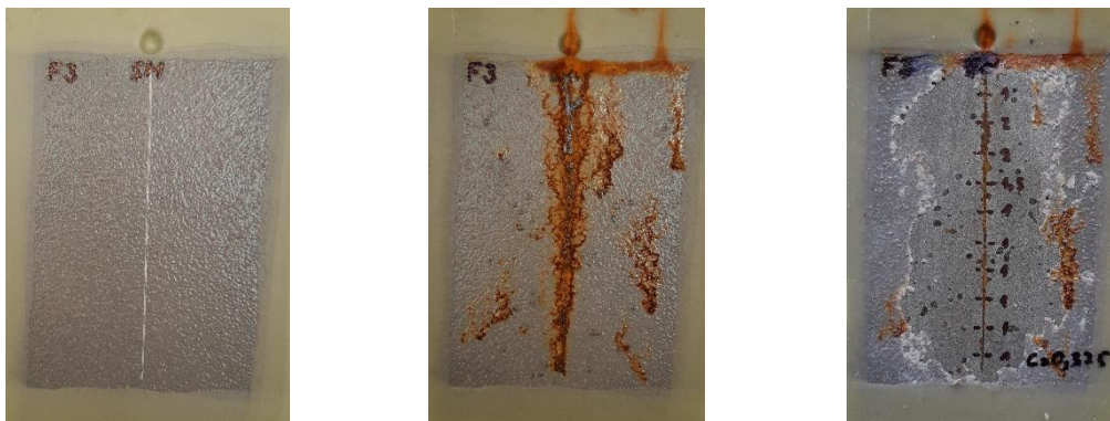
Obrázek 25 - Vzorek F3 - 0 h (vlevo), 720 h (uprostřed), koroze v okolí řezu (vpravo)
