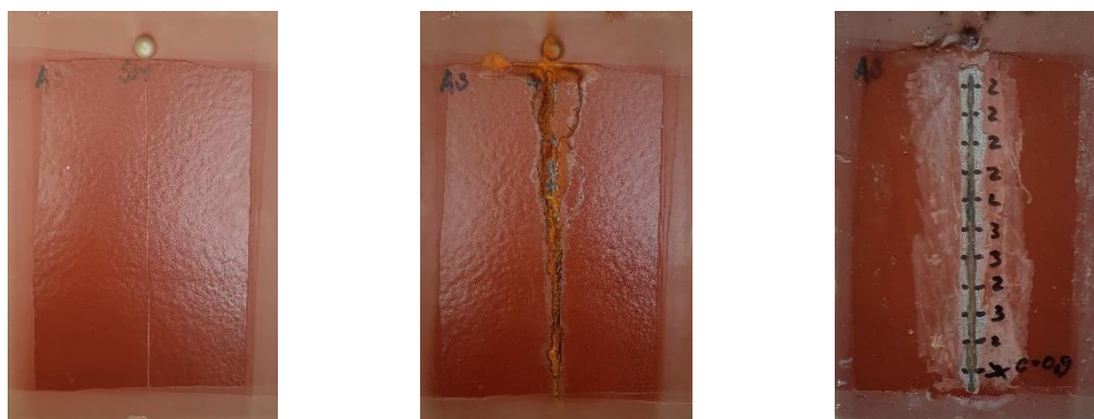
Obrázek 14 - Vzorek A3 - 0 h (vlevo), 720 h (uprostřed), koroze v okolí řezu (vpravo)
