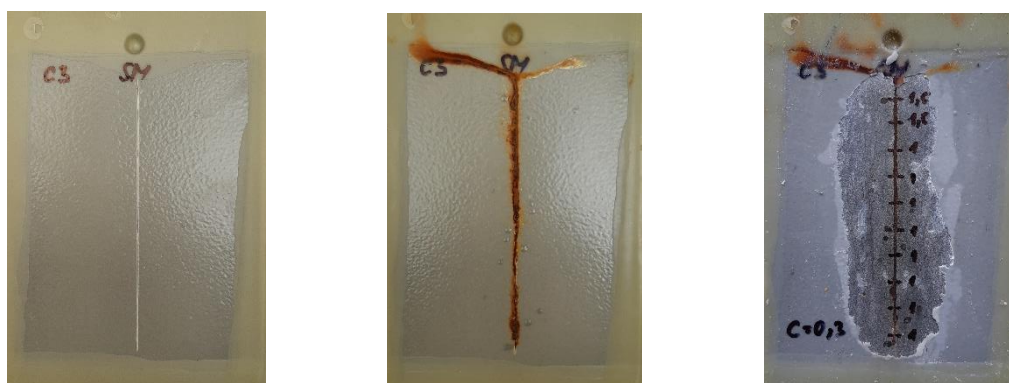
Obrázek 18 - Vzorek C3 - 0 h (vlevo), 720 h (uprostřed), koroze v okolí řezu (vpravo)
