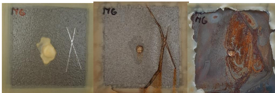
Obrázek 41 - Vzorek MG - 0 h (vlevo), 36 h (uprostřed), delaminace v okolí řezu (vpravo)
