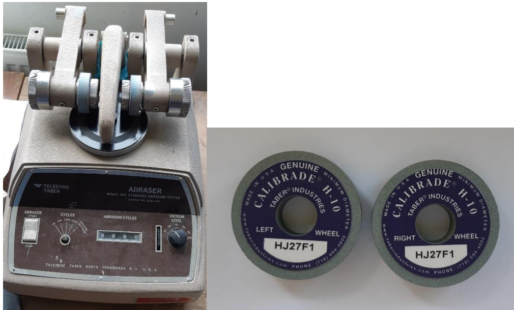
Obrázek 45 - Taber abraser (vlevo), Abrasní kotouče CALIBRADE H-10 (vpravo)
