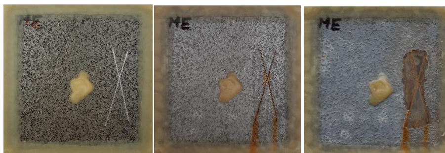
Obrázek 39 - Vzorek ME - 0 h (vlevo), 36 h (uprostřed), delaminace v okolí řezu (vpravo)
