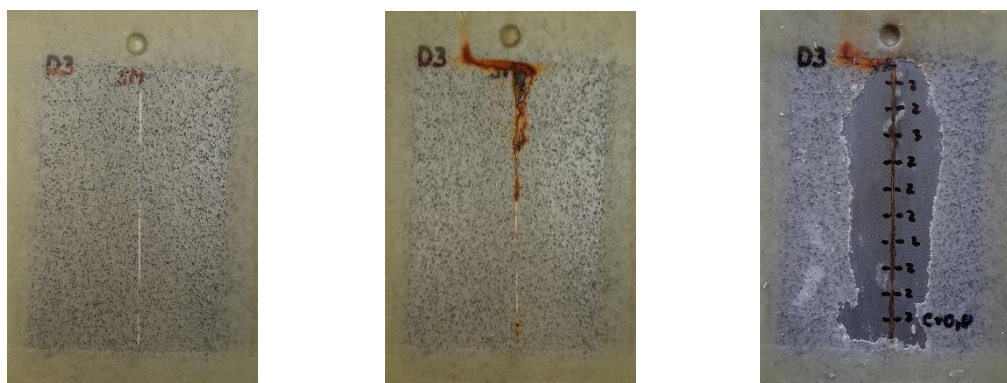
Obrázek 20 - Vzorek D3 - 0 h (vlevo), 720 h (uprostřed), koroze v okolí řezu (vpravo)
