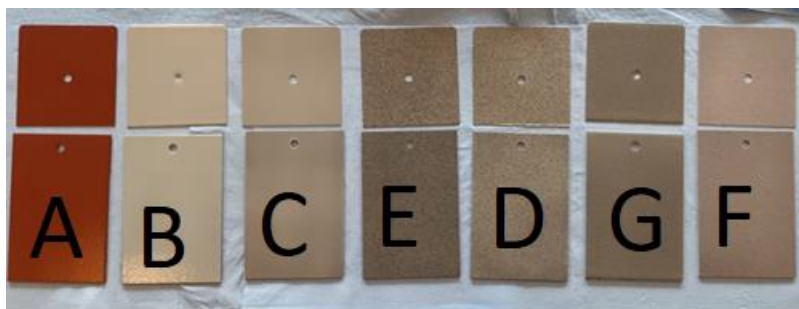
Obrázek 10 - Vzorky - Machu test + Taber abraser (horní řada), NSS + CH (dolní řada)
