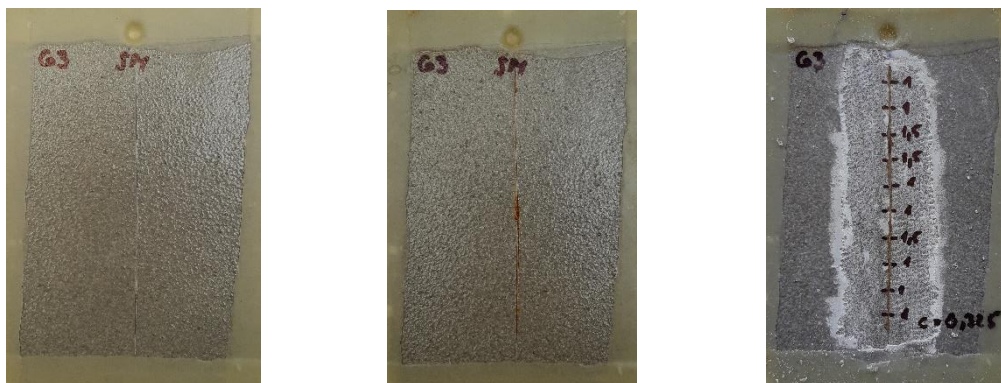
Obrázek 27 - Vzorek G3 - 0 h (vlevo), 720 h (uprostřed), koroze v okolí řezu (vpravo)
