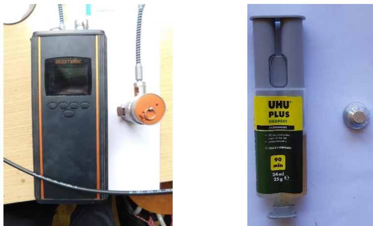
Obrázek 42 - Hydraulický odtrhoměr Elcometer 510 (vlevo), Epoxidové lepidlo UHU Plus Endfest a zkušební tělísko (vpravo)
