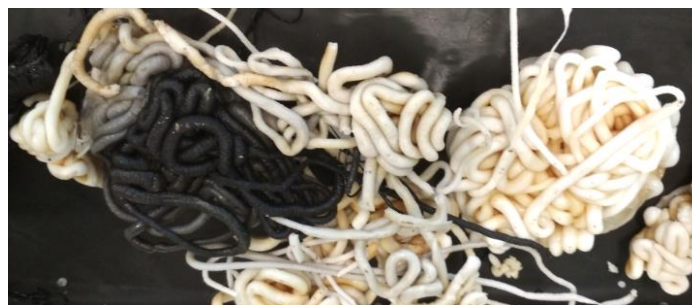
Obr. 54: Zbytky taveniny po čištění stroje
