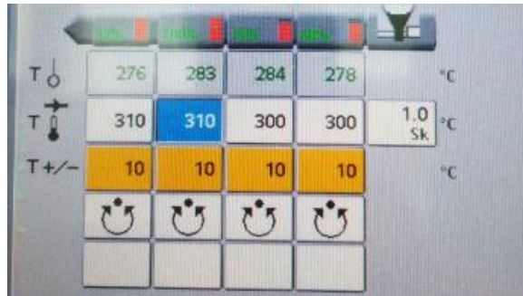
Obr. 53: Nastavené teploty topných pásů podle doporučení společnosti EMS
