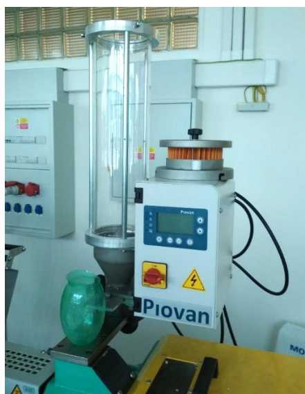
Obr. 59: Násypka tvořená seříznutým hrdlem PET lahve
