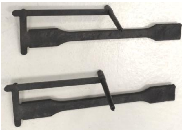
Obr. 61: Vyrobená zkušební tělíska
