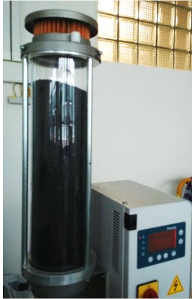
Obr. 49: Sušení granulátu PA – GF30 v sušárně PIOVAN DPA-6
