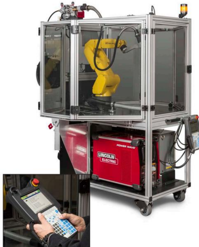
Obr. 3.16 - Výuková svařovací robotická buňka firmy FANUC se svařovacím zdrojem Lincoln Electric [26]
