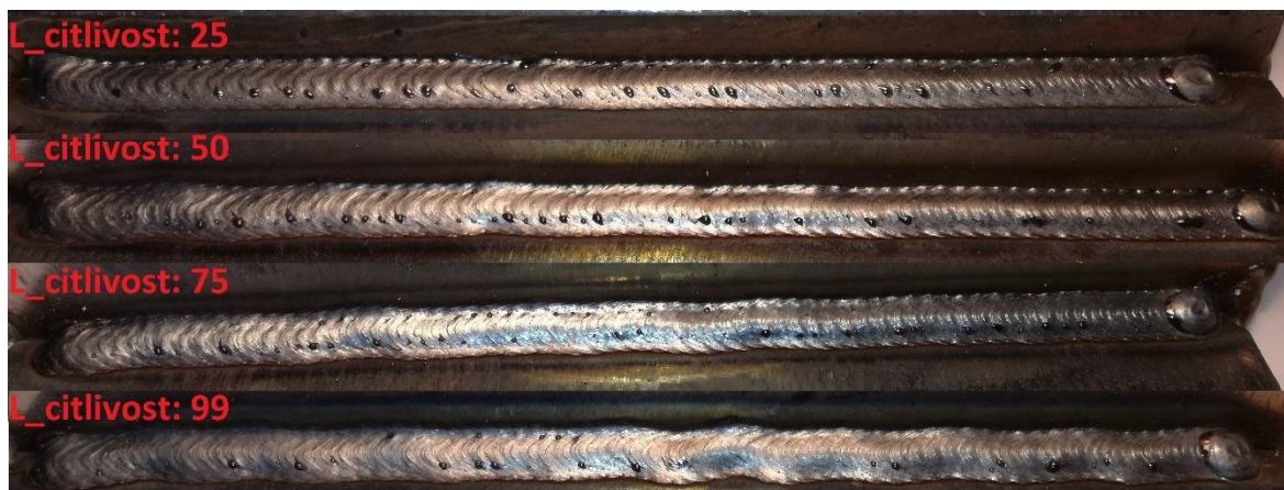
Obr. 6.28 - Testování citlivosti, odchylka 10° (pořadí vzorků: JK24, JK13, JK18, JK16)
