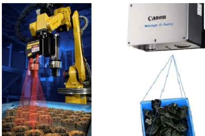
Obr. 5.5 - Optický 2D systém (vlevo) [41] a 3D systém (vpravo) [39]
