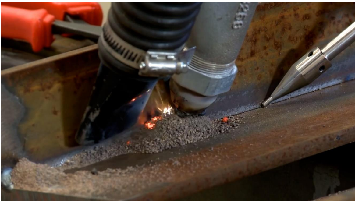
Obr. 5.3 - Využití taktilního senzoru při SAW svařování [45]
