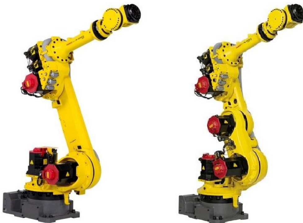
Obr. 3.20 - Roboty Fanuc, vlevo šestiosý R-1000iA130F [35], vpravo sedmiosý R-1000iA/120F-7B [36]
