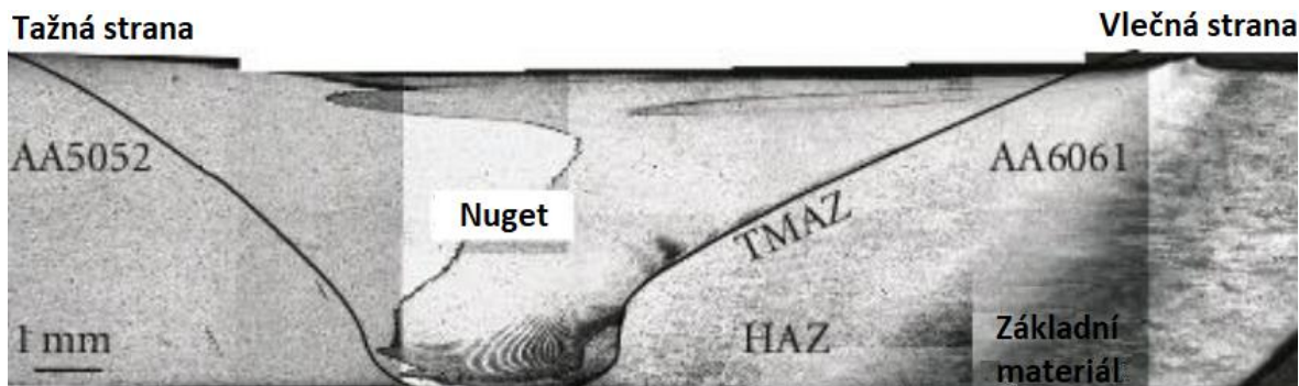
Obr. 4.13 - Metalurgický výbrus po svaření dvou hliníkových slitin EN AW-5052 a EN AW-6061 (přeloženo) [18] TMAZ = termomechanicky ovlivněná oblast, HAZ = tepelně ovlivněná oblast, Svarový nuget = dynamicky rekrystalizovaná oblast svaru
