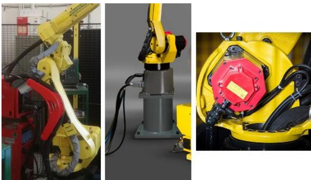
Obr. 3.21 - Porovnání robota bez duté osy (vlevo) a konstrukce s dutou první osou (vpravo) [11]
