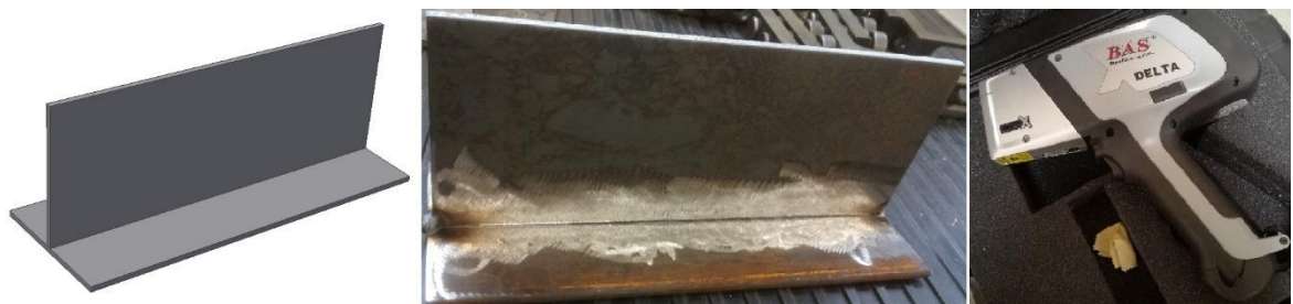
Obr. 6.3 - Připravený vzorek, Spektrometr Delta X
