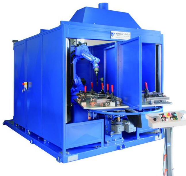
Obr. 3.14 - Kompaktní robotická svařovací buňka MOTO-Compact RVE [25]
