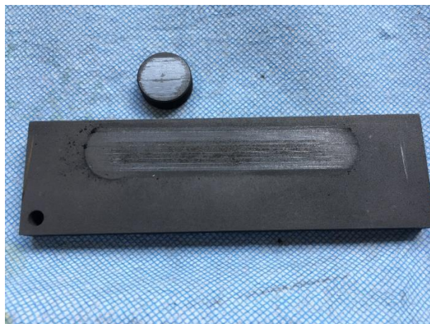
Obr. 46 Vydřená stopa kluzného laku
