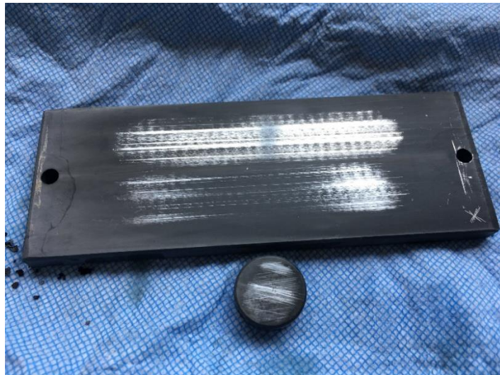
Obr. 47 Horní dráha třena na sucho a spodní s olejem
