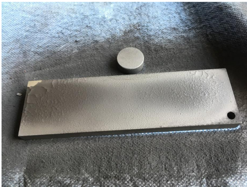
Obr. 38 Popraskaný kluzný lak
