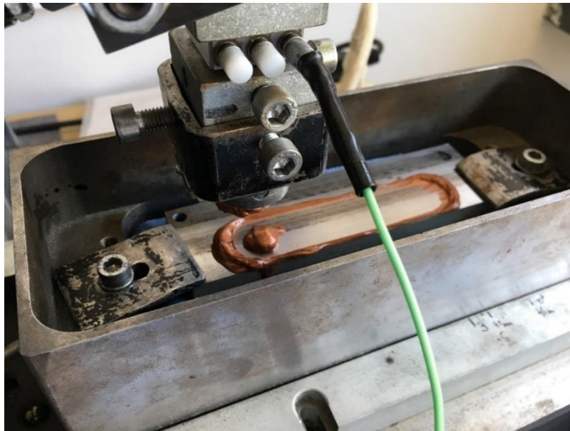
Obr. 41 Aplikace maziva- měděné pasty pod zkušební tabletu
