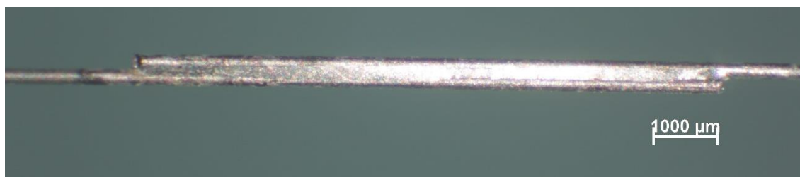
Obr. 32 Rovnoměrný spoj s hladkým průběhem pájky zhotovený při teplotě pájení 260 °C
