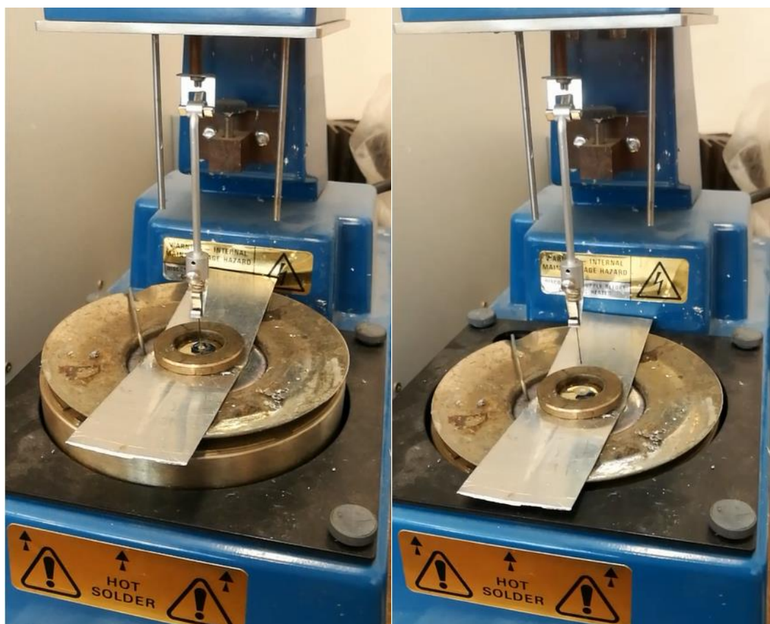
Obr. 23 Postupné ponoření nitinolového drátku do lázně s pájkou
