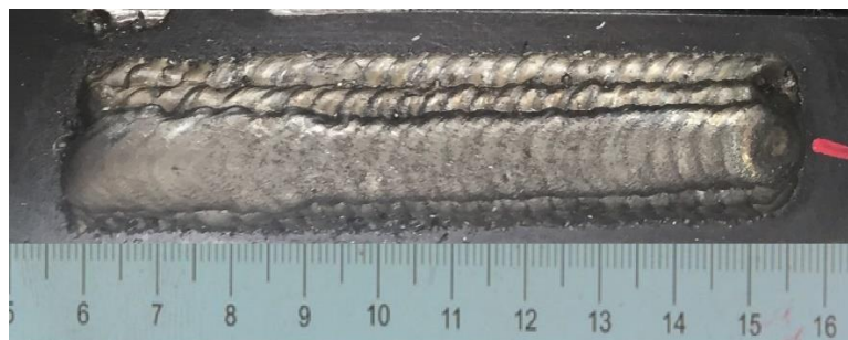
Obrázek 7-26 Návar č. 3-1 (Fesit N-P navařený na nástrojovou ocel)
