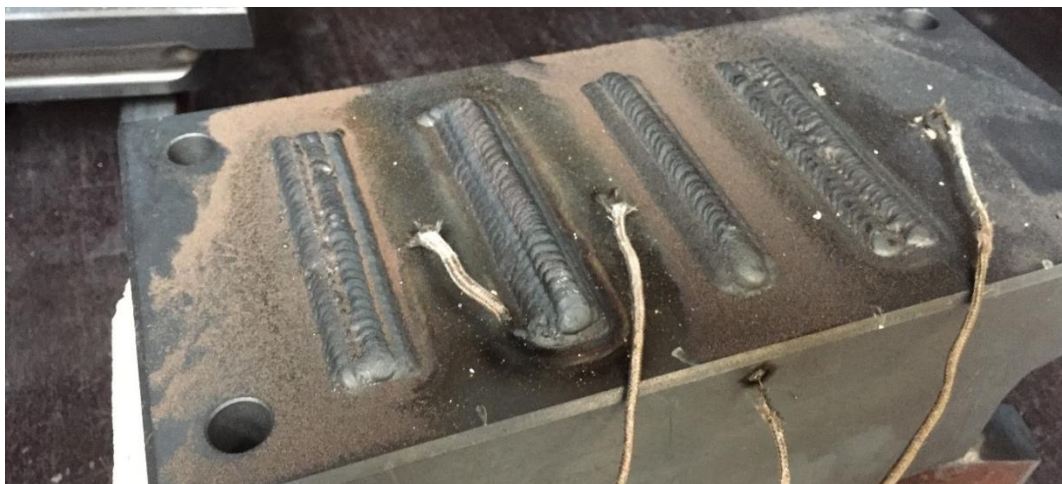
Obrázek 7-2 První sada návarů po navaření
