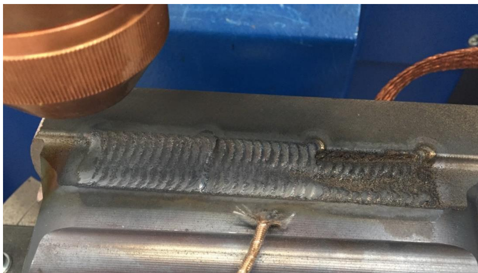
Obrázek 7-1 Testovací vzorek pro navařování rychlořezné oceli, směr navařování (pořadí v tabulce 6-1) zprava doleva
