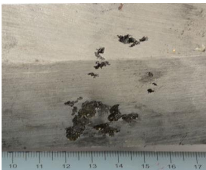
Obrázek 7-14 Vady v základním materiálu objevené při řezání vzorků pro metalografii
