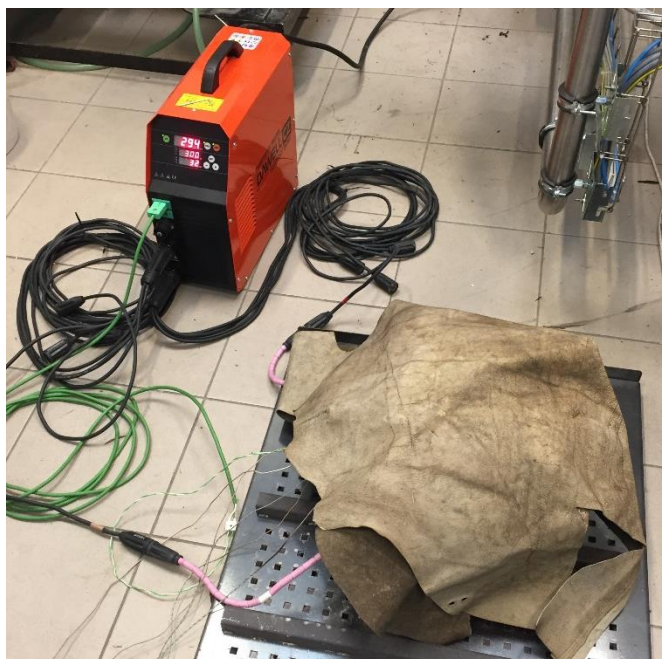
Obrázek 7-13 Zdroj pro odporový ohřev DHC6510 při tepelném zpracování 2. sady návarů HSS 30
