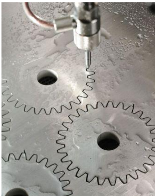
Obrázek 34 Ukázka řezání vodním paprskem [10]
