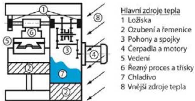
Obr. 2: Zdroje a propady tepla v obráběcím stroji [7].
