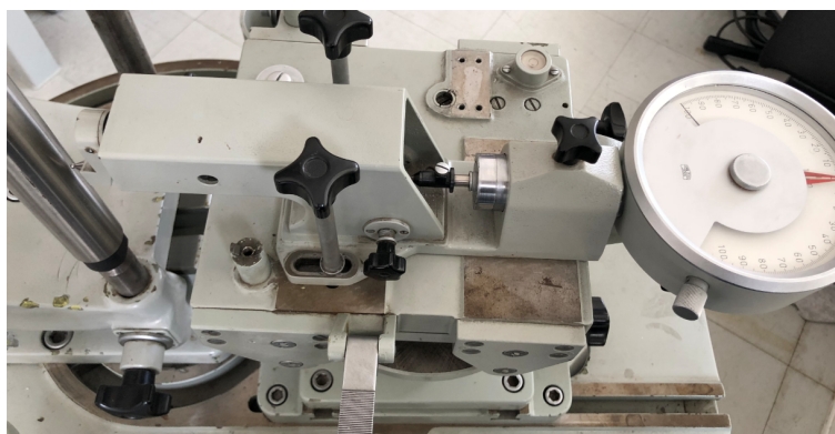
Obrázek 4.13: Určování opakovatelnosti pomocí kalibračního válce
