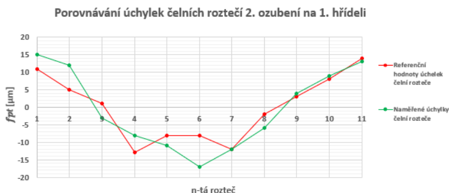
Obrázek 4.23: Porovnávání úchylek čelních roztečí 2. ozubení na 1. hřídeli s refer. hodnotami
