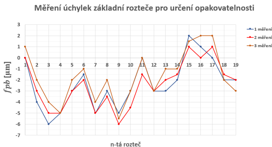
Obrázek 4.17: Měření úchylek základní rozteče pro určení opakovatelnosti
