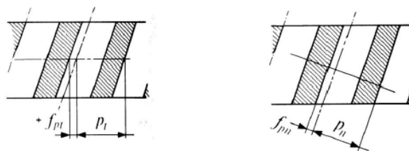
Obrázek 3.7: Vztah mezi čelní rovinou a normálovou rovinou[4]
