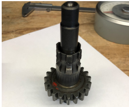
Obrázek 4.15: Čelní ozubené kolo s přímými zuby
