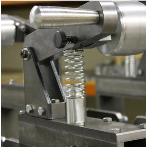
Obr. 17: Napnutí pásu tlačnou pružinou [23]
