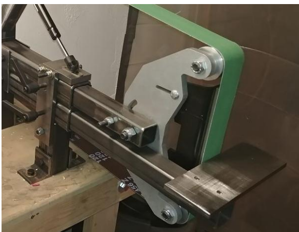
Obr. 19: Konstrukce stolu se čtvercovým profilem [15]
