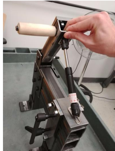
Obr. 18: Napnutí pásu pomocí tlumiče [24]
