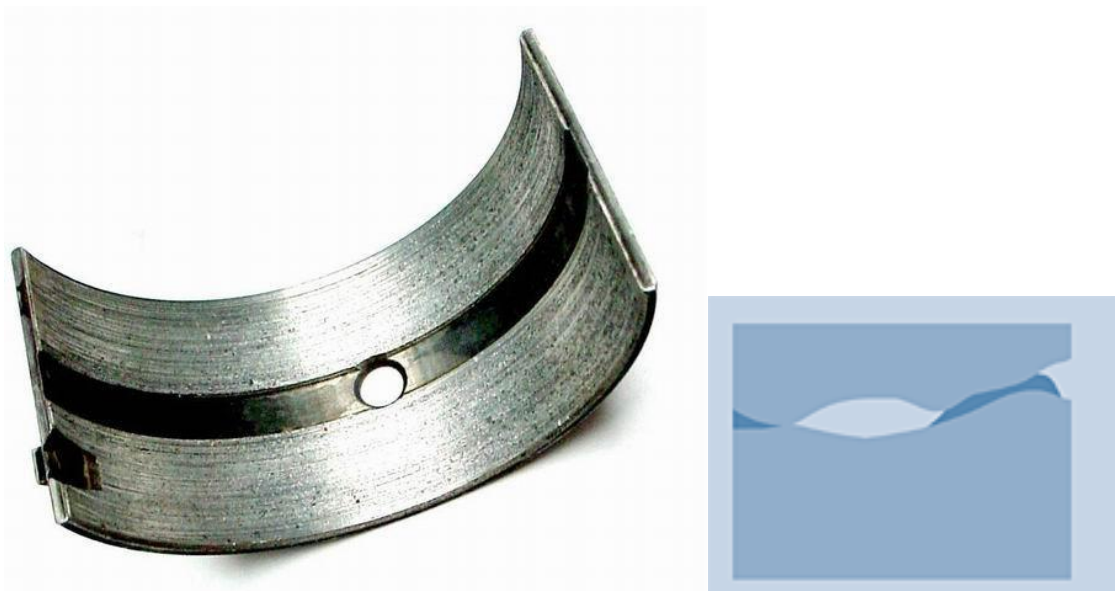
Obr. 8 Adhezivní opotřebení - ojníční pánev a schéma [9, 11]
