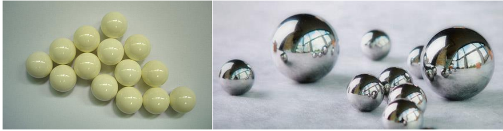
Obr. 22 Tělísko „Pin“ ve formě kuličky z Al_2O_3 a oceli (ČSN 14 109) [24]
