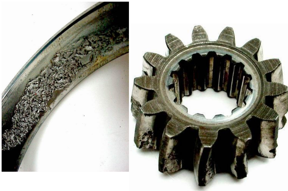
Obr. 11 Únavové opotřebení - kroužek ložiska, zuby ozubeného kola [11]
