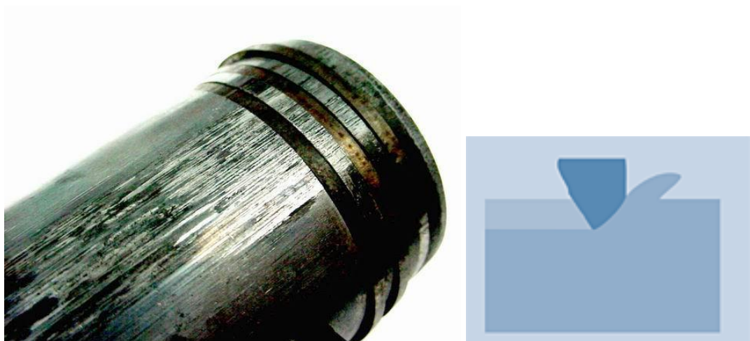
Obr. 9 Abrazivní opotřebení - píst spalovacího motoru a schéma [9, 11]
