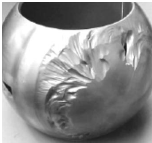
Obr. 10 Erozivní opotřebení - kulový ventil uzávěru [11]
