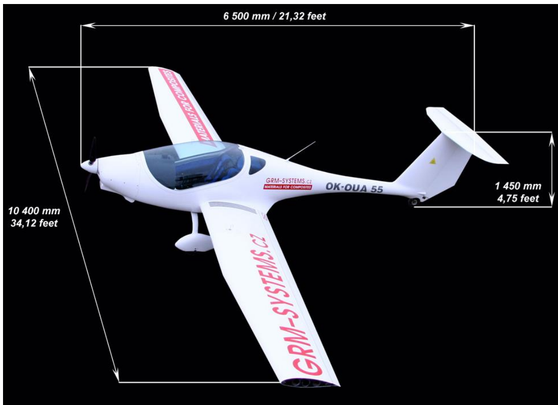
Obrázek 2 Rozměry letounu Phoenix Air pro variantu bez nástavců a wingletů [1]
