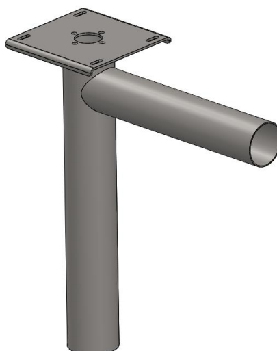
Obr. 31: Vývod - odsávací trubice s přírubou
