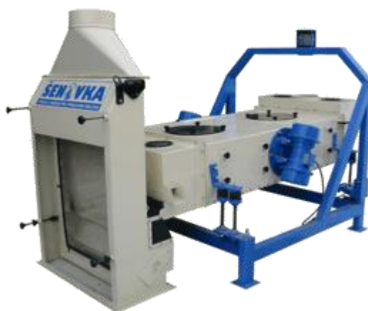
Obr. 5: Sítový třídič předčistírenský PSVT (R) 50 [11]
