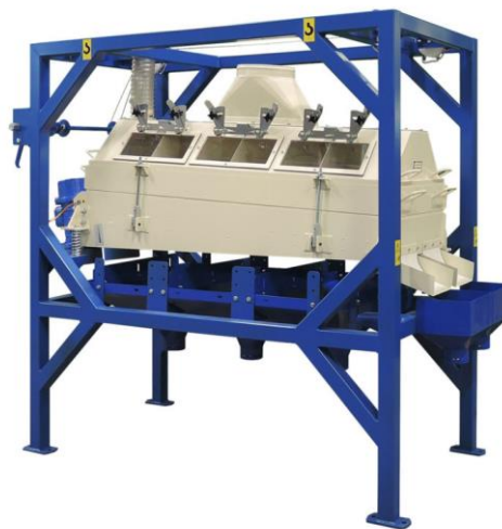
Obr. 3: Vzduchový síťový třídíč [9]
