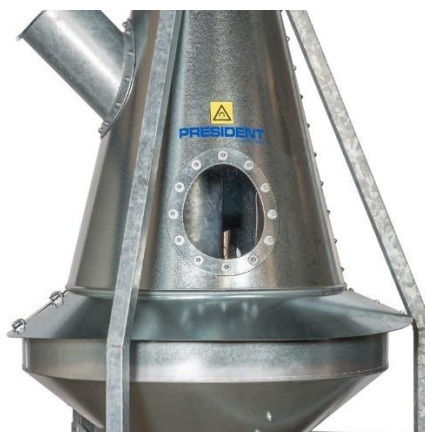
Obr. 13: „Aspiration cleaners“ Aspirační čistič [16]
