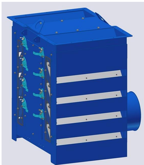
Obr. 6: Aspirační skříň FAS 500 [12]
