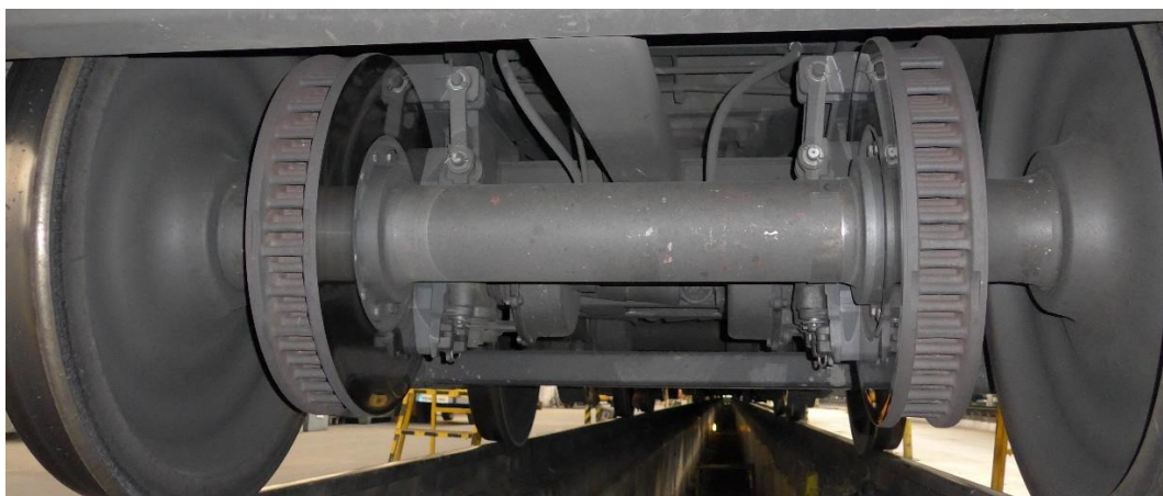
Obr. 32: Dvojkolí osobního kolejového vozu se dvěma brzdovými kotouči
