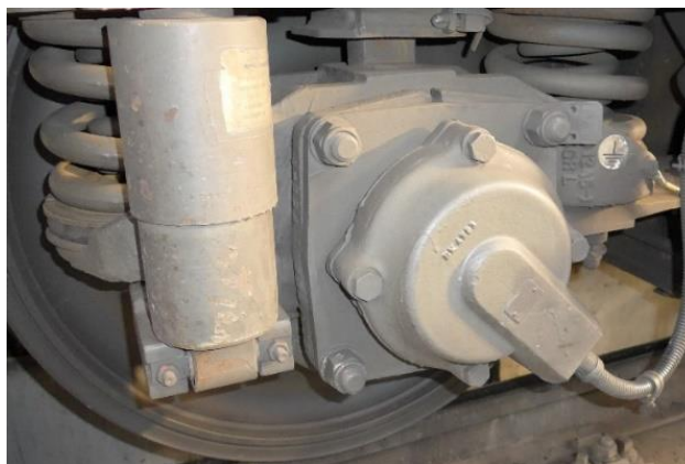
Obr. 29: Uložení generátor protismyku DAKO na nápravě vozu
