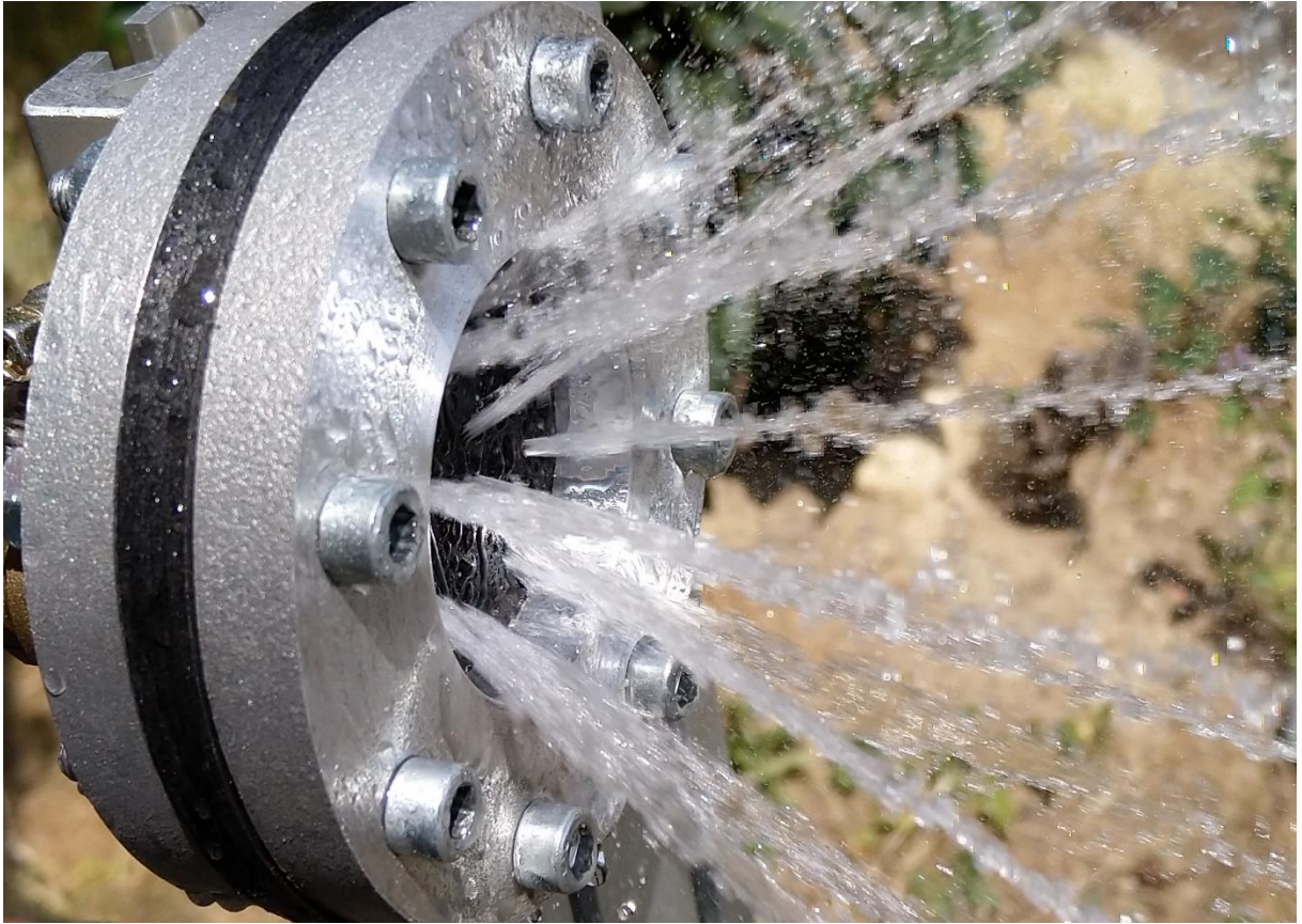
Obrázek 72: Vstříkovací otvory větve oksyličovaadla při p_o = 1 \text{ bar} a \dot{m}_o = 0,257 \frac{\text{kg}}{\text{s}} (pohled ze strany přítoku)
