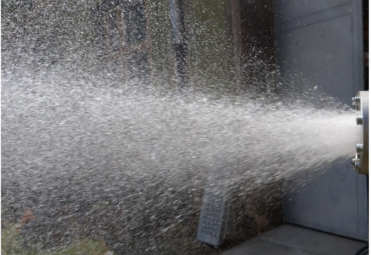
Obrázek 75: Pohled z boku na kužel kapiček při 2,5 bar v obou větvích a průtocích \dot{m}_p = 0,292 \frac{kg}{s} a \dot{m}_o = 0,404 \frac{kg}{s}
