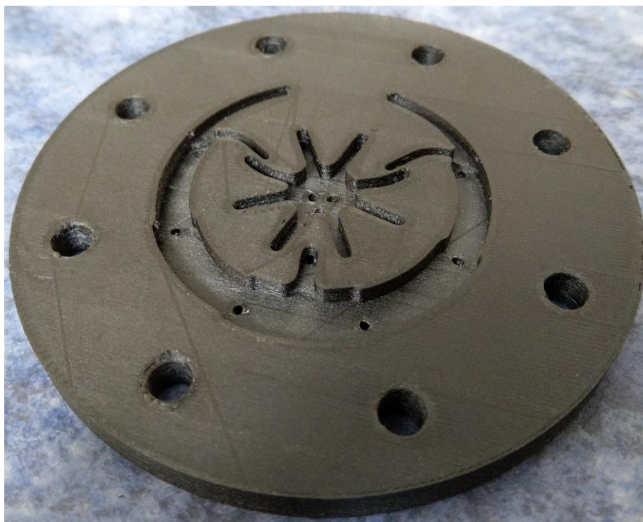
Obrázek 62: Detail kanálků 3D tisku čela vstříkovače
