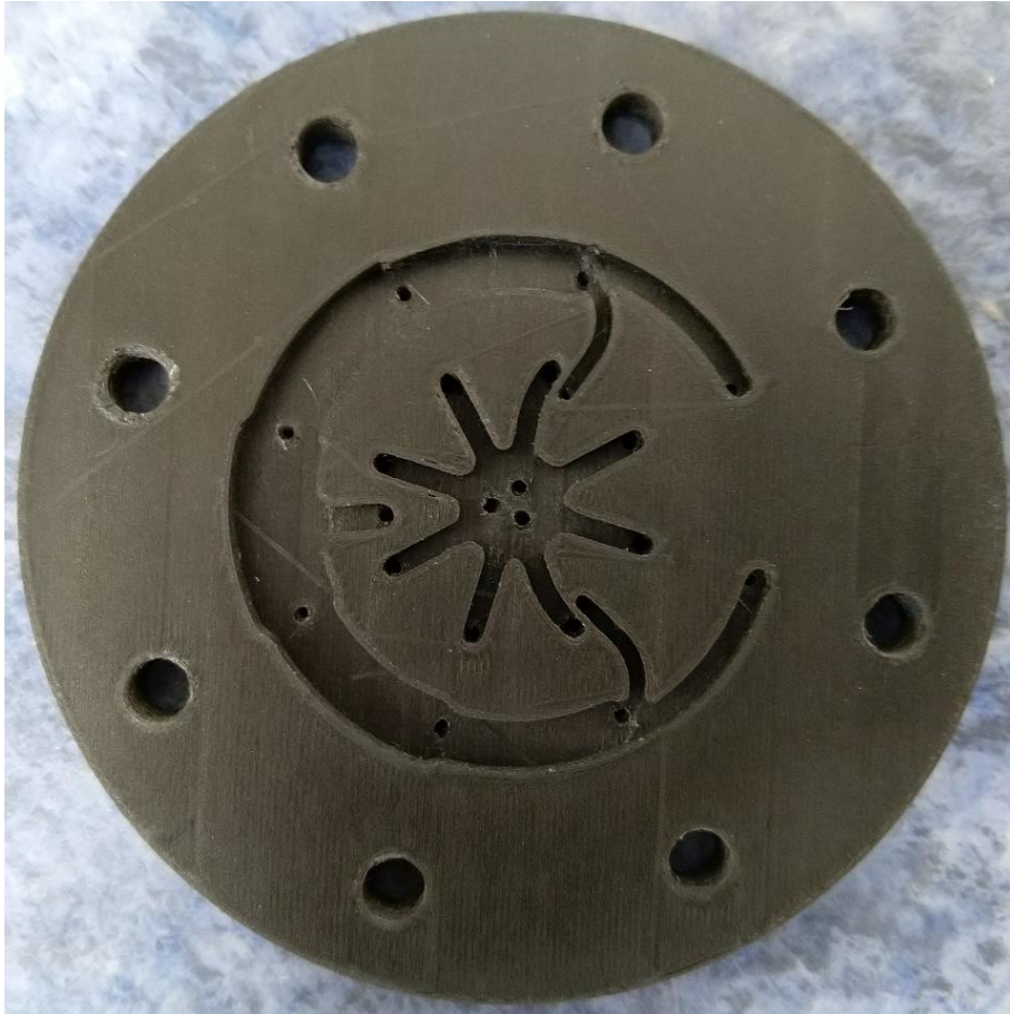
Obrázek 63: Detail kanálek 3D tisku čela vstříkovače
