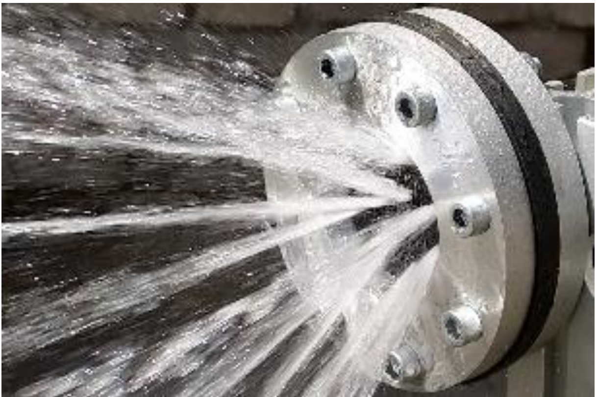
Obrázek 73: Vstříkovací otvory větve oksyličovaadla při p_o = 1,8 \text{ bar} a \dot{m}_o = 0,336 \frac{\text{kg}}{\text{s}} (pohled z druhé strany přítoku)
