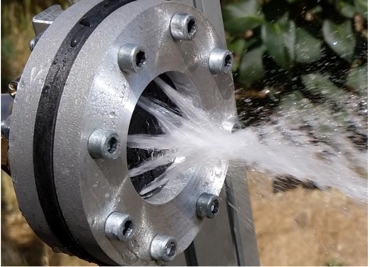
Obrázek 70: Vstříkovací otvory větve paliva při p_p = 1 \text{ bar} a \dot{m}_p = 0,166 \frac{\text{kg}}{\text{s}} (pohled ze strany přítoku)
