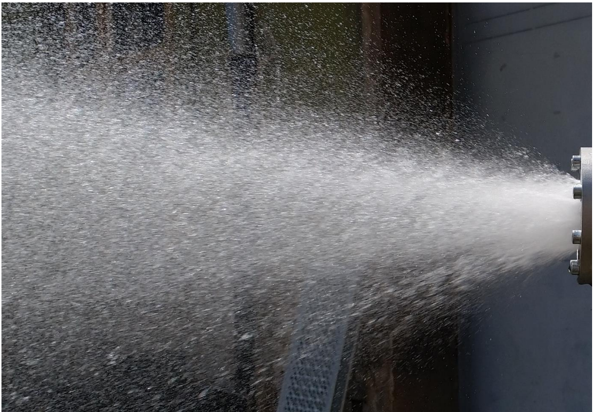
Obrázek 76: Pohled z boku na kužel kapiček při 4 bar v obou větvích a průtocích \dot{m}_p = 0,336 \frac{kg}{s} a \dot{m}_o = 0,479 \frac{kg}{s}
