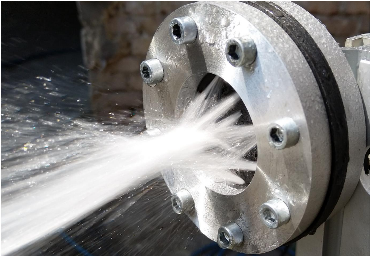
Obrázek 71: Vstříkovací otvory větve paliva při p_p = 2 \text{ bar} a \dot{m}_p = 0,246 \frac{\text{kg}}{\text{s}} (pohled z druhé strany přítoku)
