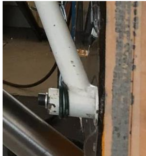
Obrázek 41 – Očekávané provedení svaru ve spoji prutu se závěsem lože [4]
