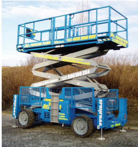
Obr.: 3 Pojízdná stavební plošina [12]
