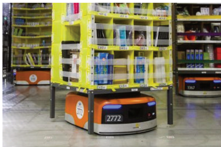
Obr.: 15 Robotické vozítka Amazon robotics [21]
