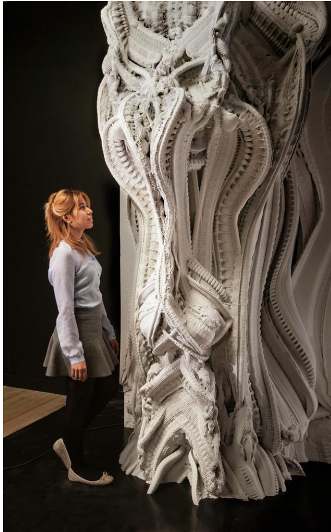
Obrázek 2.: Ukázka arabeskové stěny vzniklé metodou spojováním kameniva [9]
