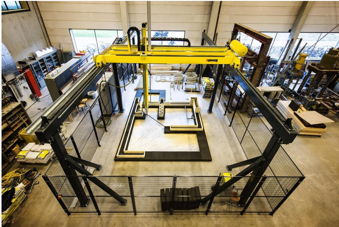
Obrázek 7.: Ukázka rámové konstrukce 3D tiskárny v mostové variantě [3]
