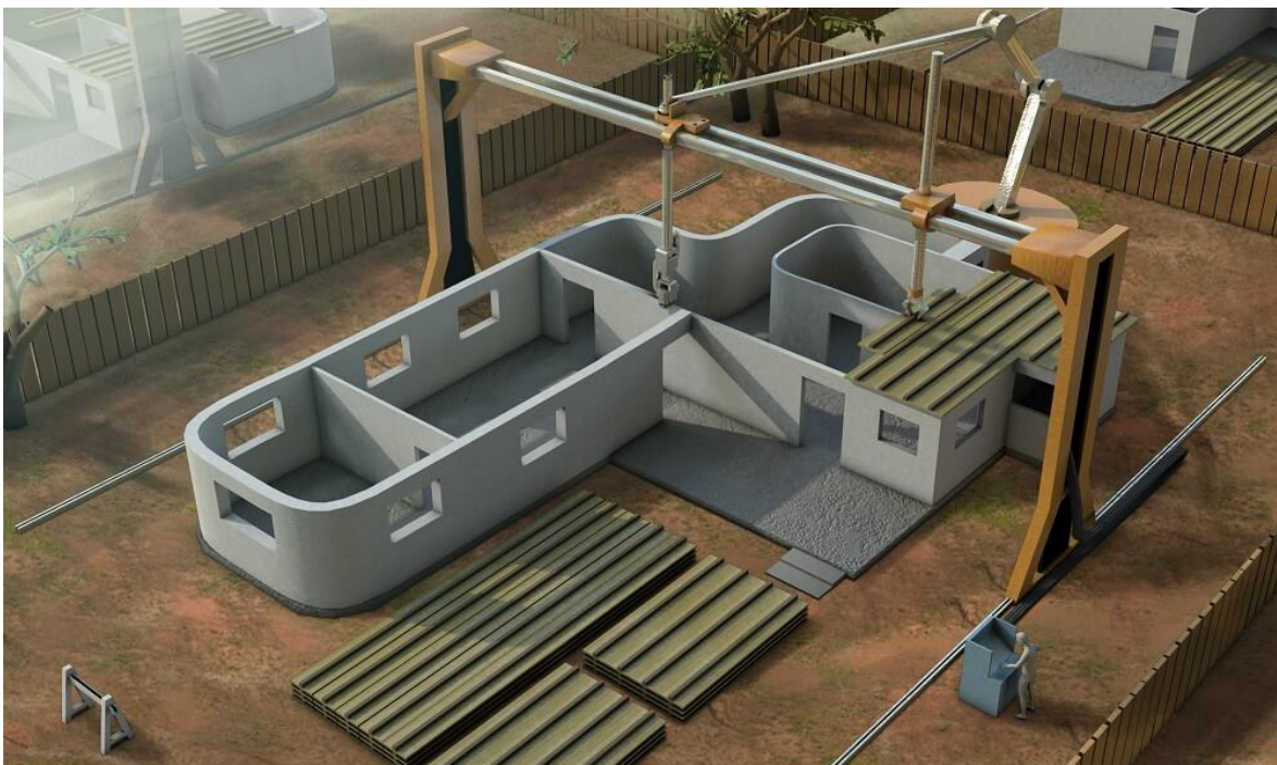
Obrázek 8.: Ukázka rámové konstrukce portálové varianty firmy CCC [4]
