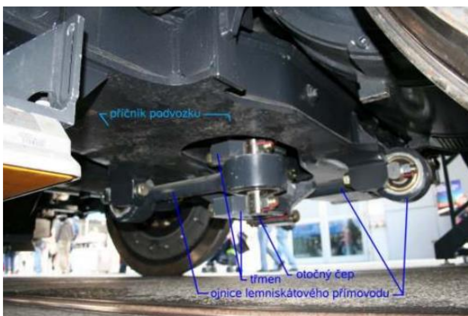
Obr. 8: Mechanismus uchycení skříně k podvozku Škody 109E [13]
