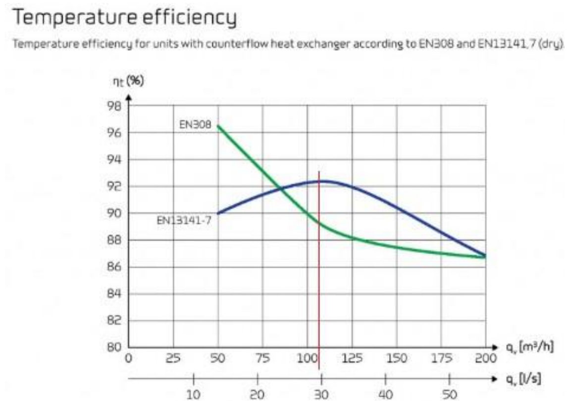
Obr. 5.1 Teplotní účinnost v závislosti na průtoku NILAN CT 200 [16]
