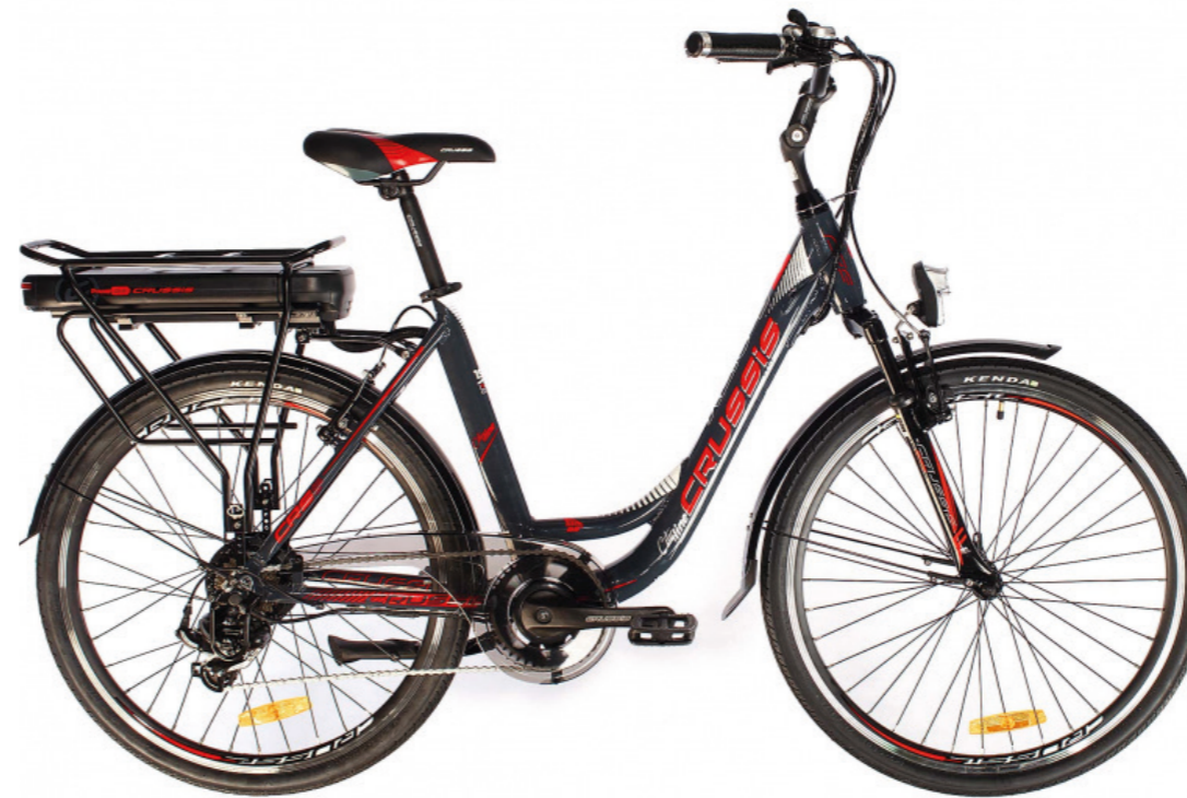
Městské elektrokolo Crussis, model e-City 1.10 - S, motor umístěn v zadním náboji kola, baterie Li-Ion umístěna na rámu s dojezdem až 120 kilometrů, hmotnost 22 kilogramů, materiál hliník.
