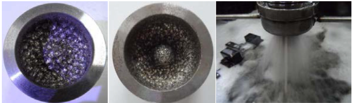
Obrázek 2.14: Výsledky hrubování porézni a plnou elektrodou a fotografie průběhu obrábění
