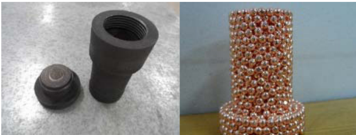
Obrázek 2.12: Forma pro výrobu a vlastní sesintrovaná elektroda
