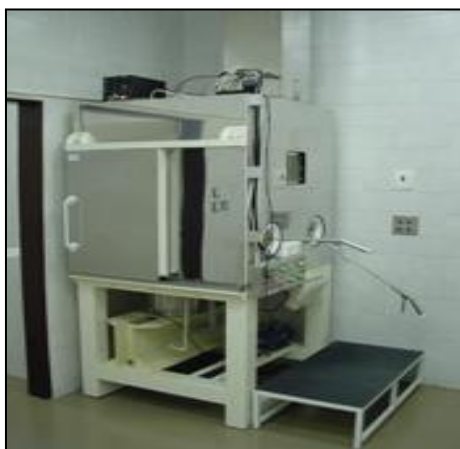
a) Digestoř s manipulátory [91]
