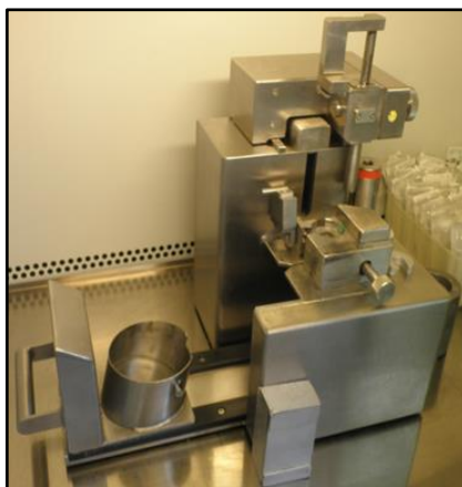
Obrázek 3 Příklad automatického zařízení pro dávkování radiofarmaka
