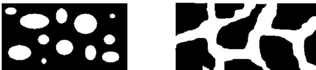
Obrázek 19 Rozdíl mezi uzavřenými a otevřenými póry v sanační omítce
