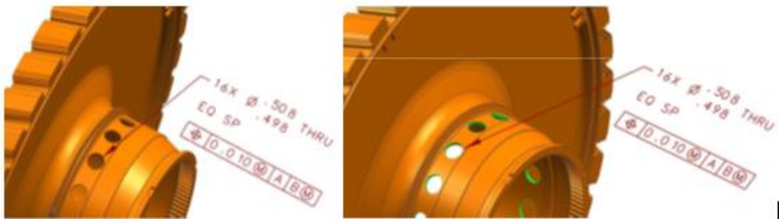
Obrázek 3 Rozdíl mezi prezentačními (vlevo) a reprézentačními (vpravo) PMI daty [18]
