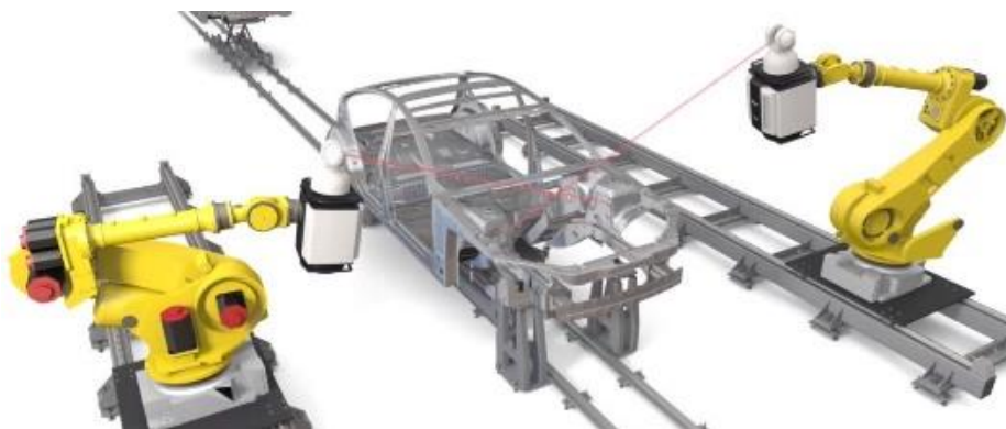
Obrázek 15 – Měření karoserie automobilu pomocí laser radaru [16]
