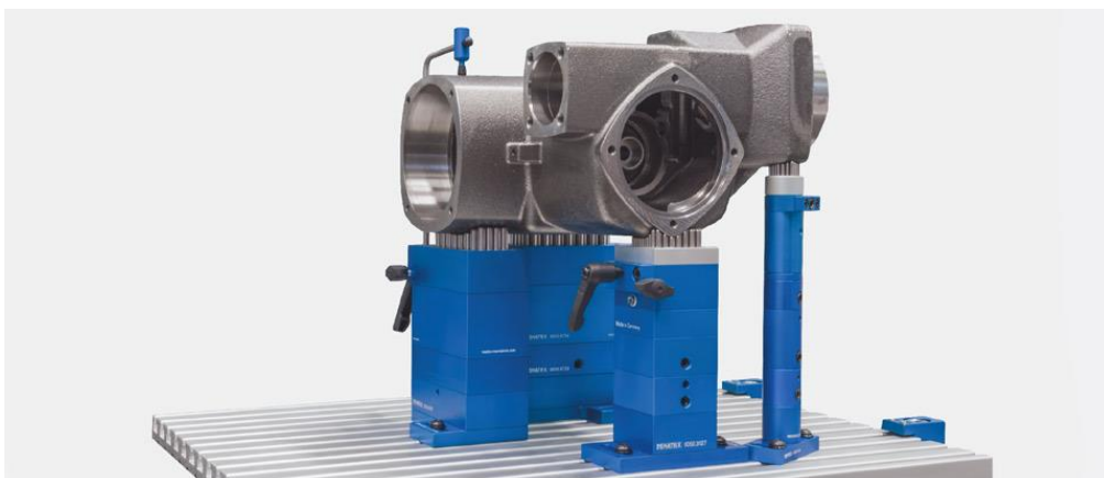
Obrázek 32 - Upnutí pomocí systému Matrix [43]
