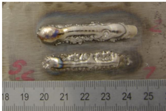
Obrázek 37. Další zkušební návary Titanu Grade 1 z navařovacího přípravku
