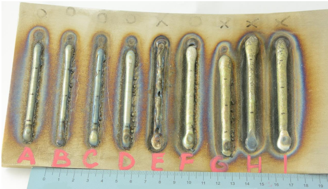
Obrázek 24. Základní materiál s navařenými zkušebními návary A - I
