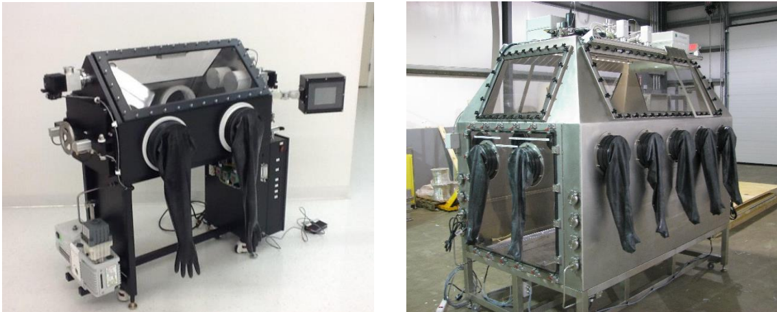
Obrázek 14. Komory určené pro ruční svařování titanu a jeho slitin [59] [60]
