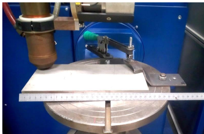
Obrázek 23. Umístění základního materiálu na navařovacím automatu
