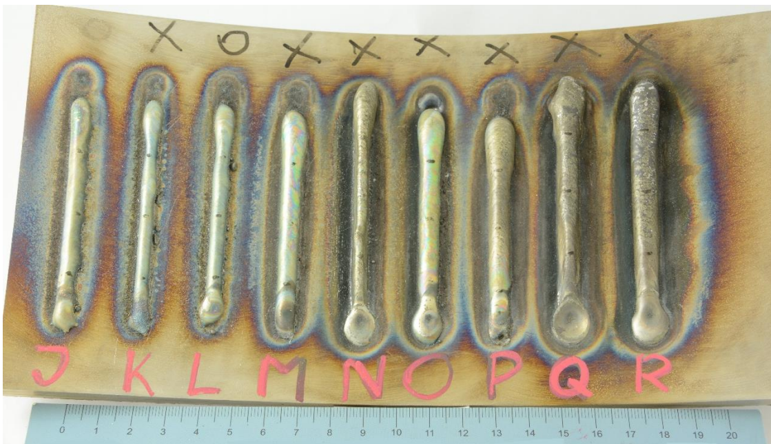
Obrázek 25. Základní materiál s navařenými zkušebními návary J - R
