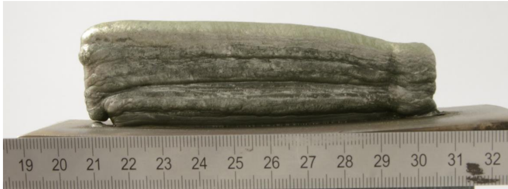
Obrázek 27. Finální 3D objekt z vysoko-kobaltové slitiny, boční pohled
