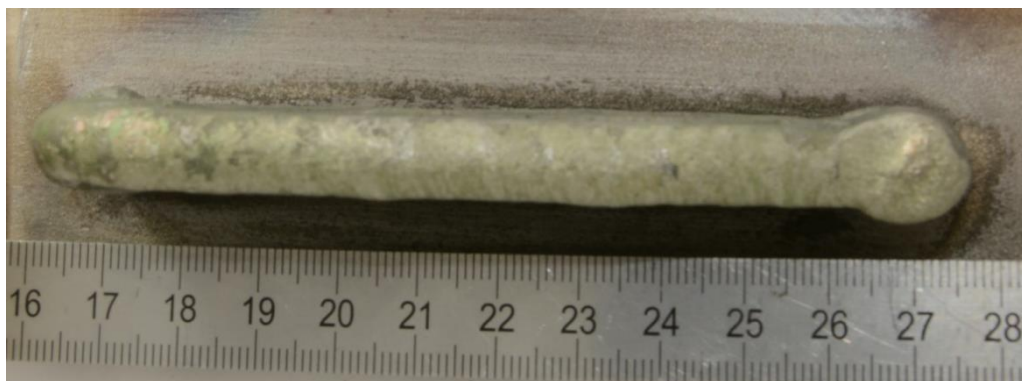
Obrázek 28. Finální 3D objekt z vysoko-kobaltové slitiny, pohled shora
