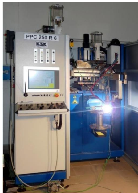
Obrázek 20. Navařovací automat PPC 250 R6 (KSK s.r.o. Česká Třebová)
