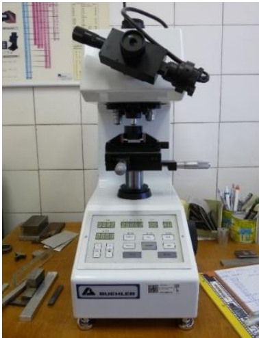
Obrázek 40. Mikrotvrdoměr IndentaMET 1104 (Buehler) a pohled na vzorek při probíhajícíím měření mikrotvrdosti
