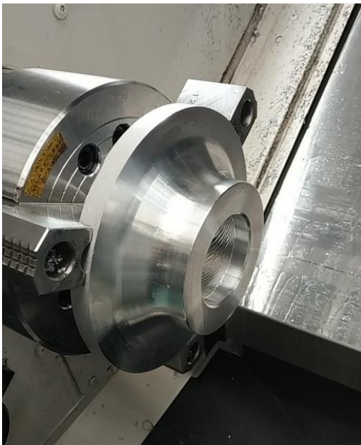
Obr. 35: Upnutý obrobek (první operace)
