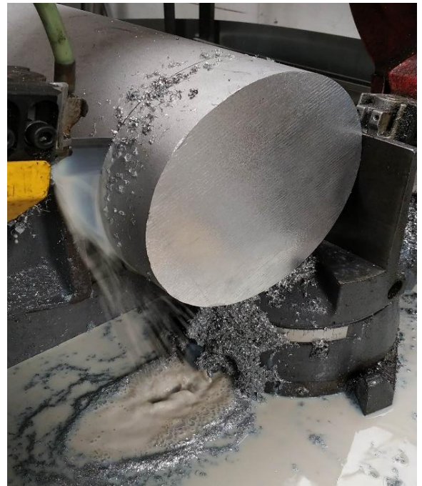
Obr. 32: Řezání polotovaru na pásové pile (detail)
