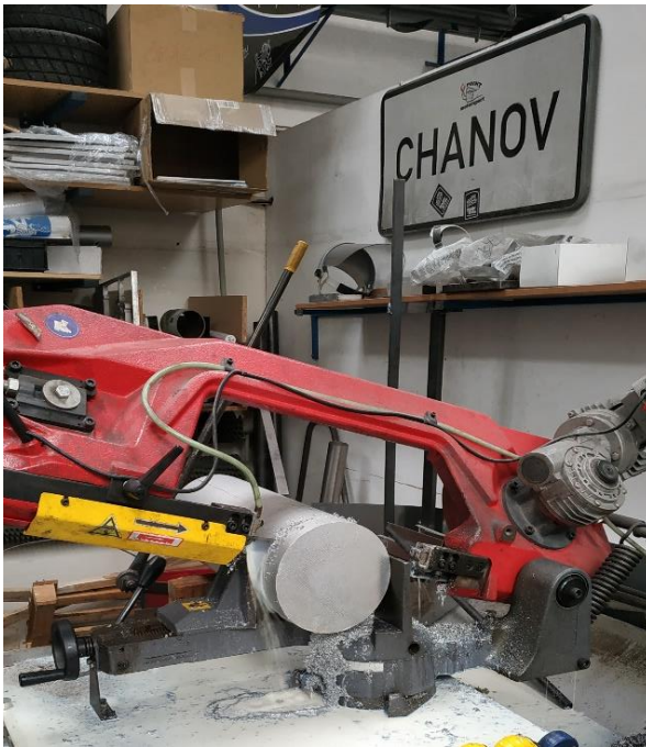
Obr 31: Řezání polotovaru na pásové pile
