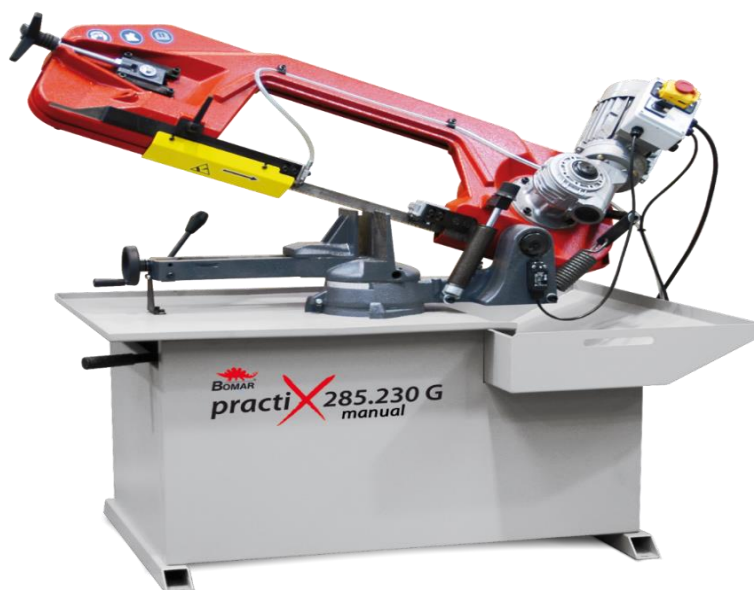
Obr 12: Pásová pila Bomar practix 285.230 G [18]
