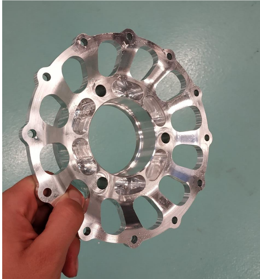
Obr. 43: Vyrobený střed kola I
