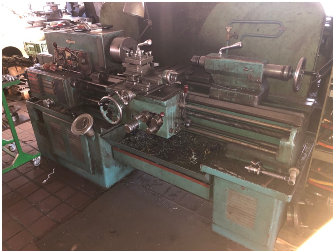
Obr 3.24 Konvenční soustruh TOS SV 18 [Autor]
