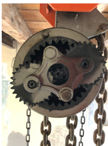
Obr 2.21 Mechanismus kladkostroje [Autor]
