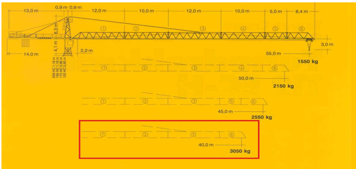
Obrázek 12 – Schéma únosnosti věžového jeřábu [11]
