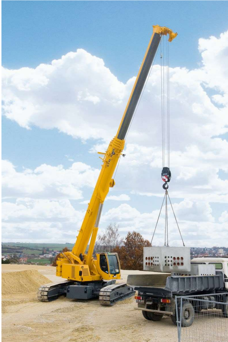
Obr. 7 Jeřáb na pásovém podvozku Liebherr LTR 1060 [10]
