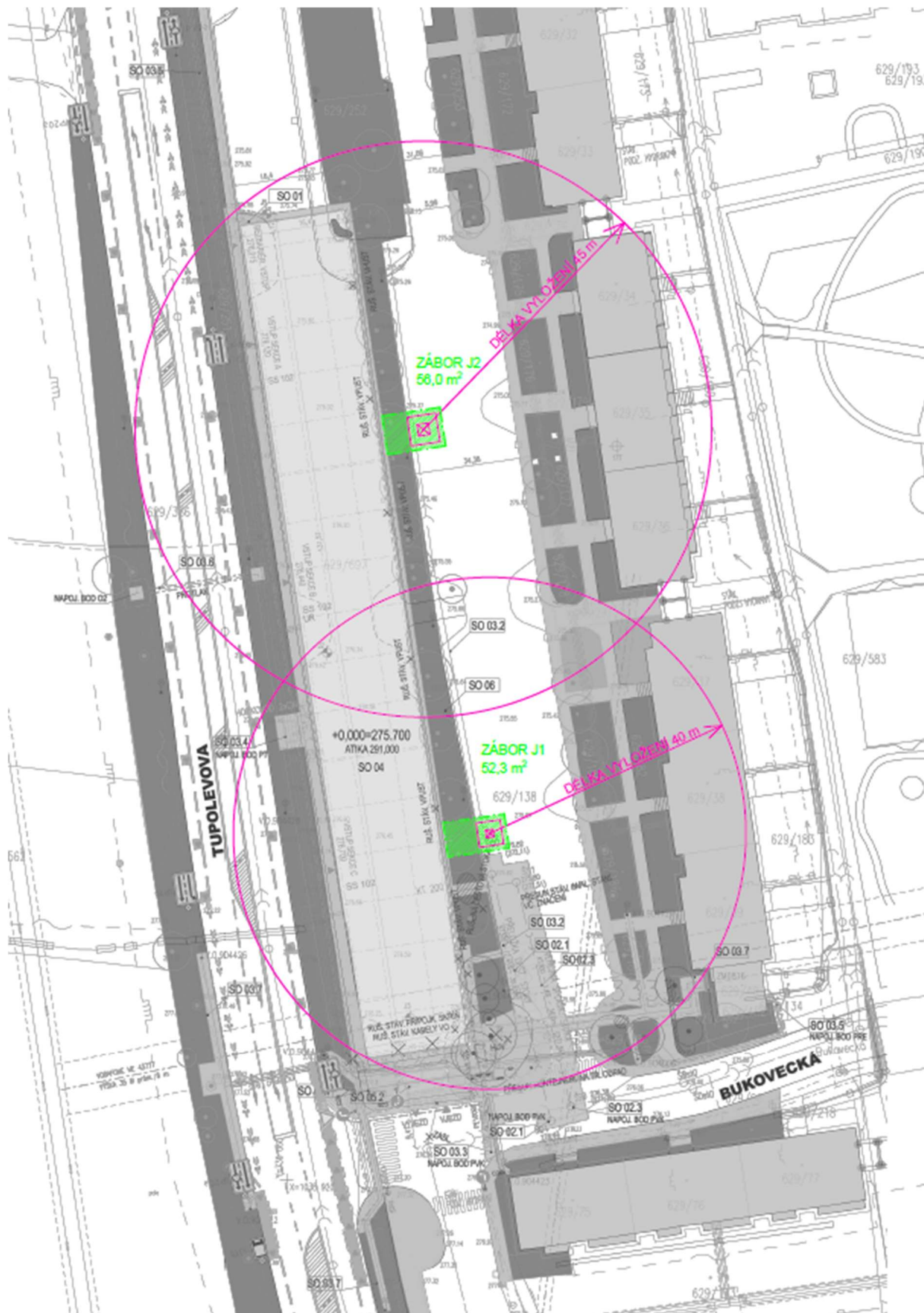
Obr. 36 Umístění jeřábů do situace var. 2
