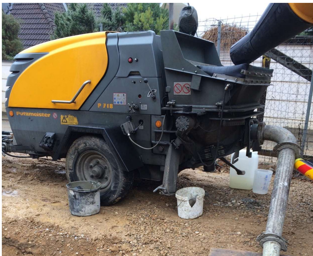
Obr. 21 Pístové stabilní čerpadlo PUTZMEISTER P 718 TD [25]
