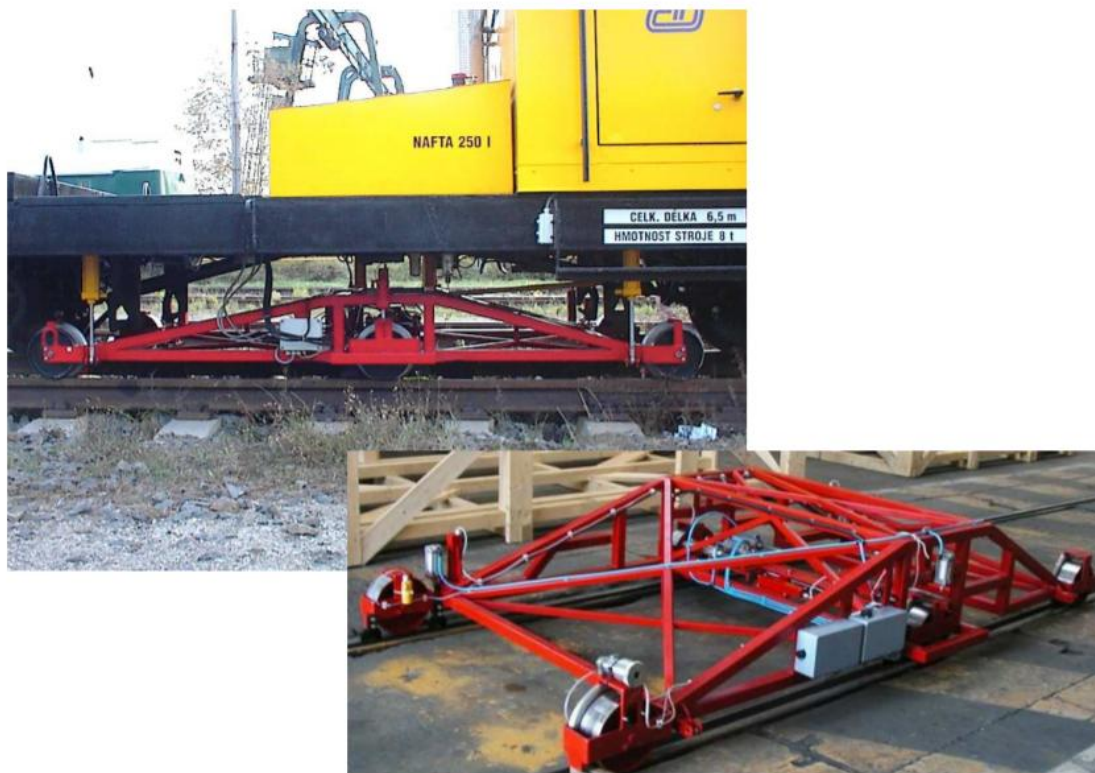
Obr. 3.3 - Měřicí podvozek a jeho umístění v rámci malé měřicí drezíny [10]
