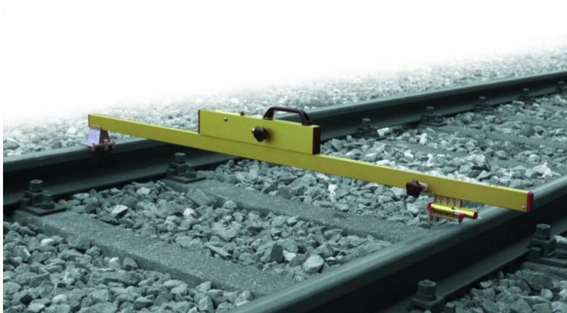
Obr. 3.6 - Ruční výhybková rozchodka s vodováhou typu ROBEL 83.07 [16]
