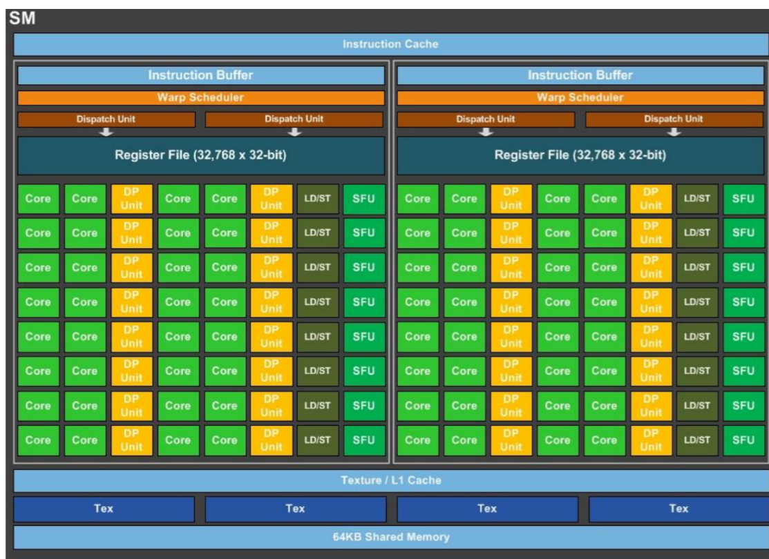
Obr. 2.1: Schéma fyzického usporiadania multiprocesoru prevzané z [6]
