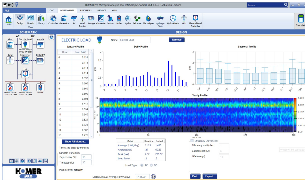
Obr. 5.9 Modelování v HOMER. 58 Levá část ukazuje schéma systému, v centrální části je prezentováno elektrické zatížení.
