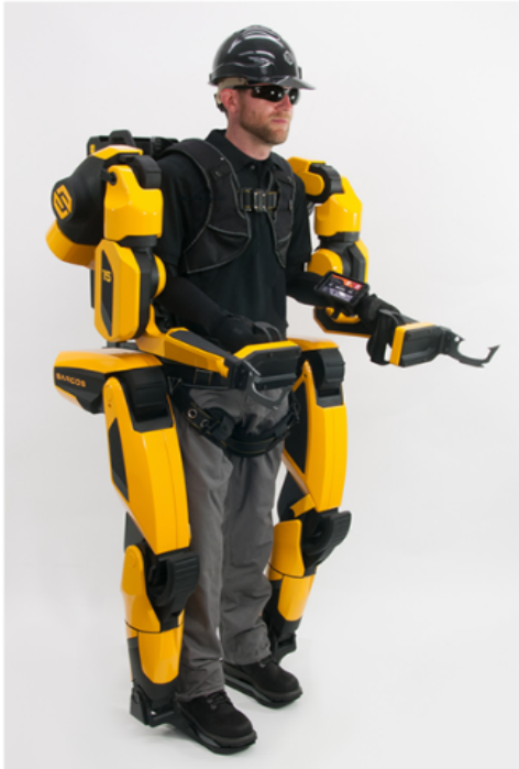
Fig. 28 Guardian XO Max exoskeleton. 117
