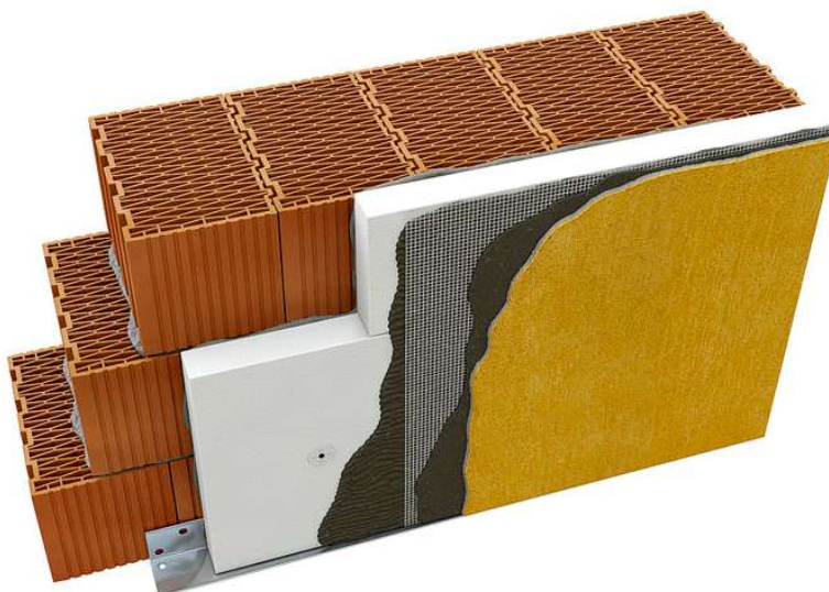
Obrázek 8: Schéma kontaktního zateplení
