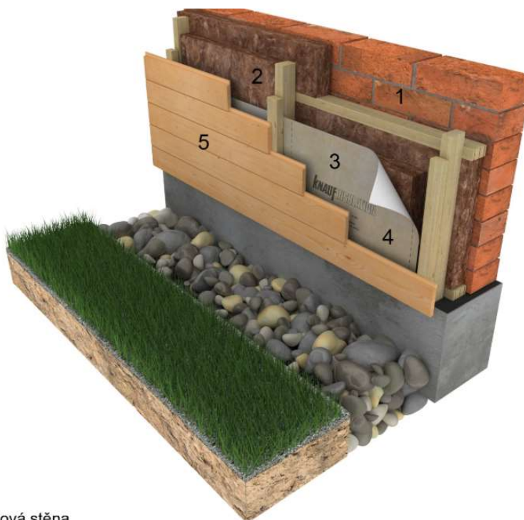
Obrázek 9: Schéma bezkontaktního zateplovacího systému
