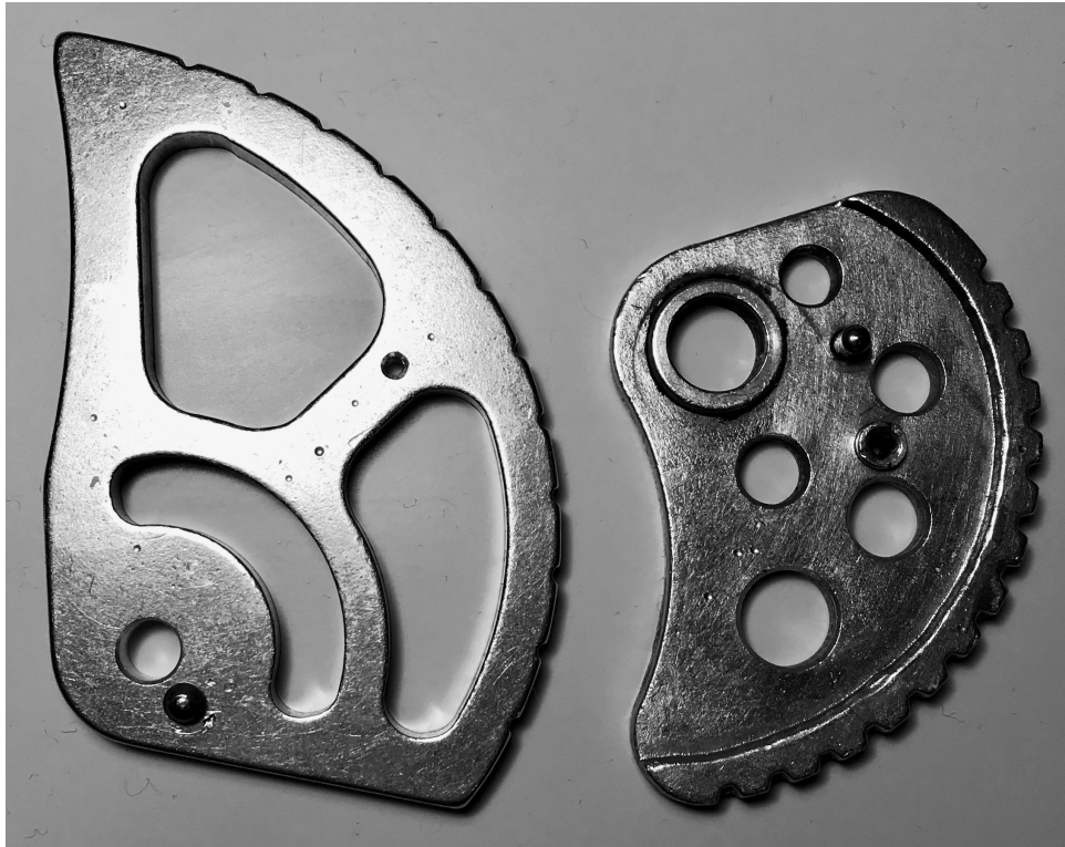
Obr.14 Zkušební materiál – segmenty (obráběný vlevo, kovaný vpravo)
