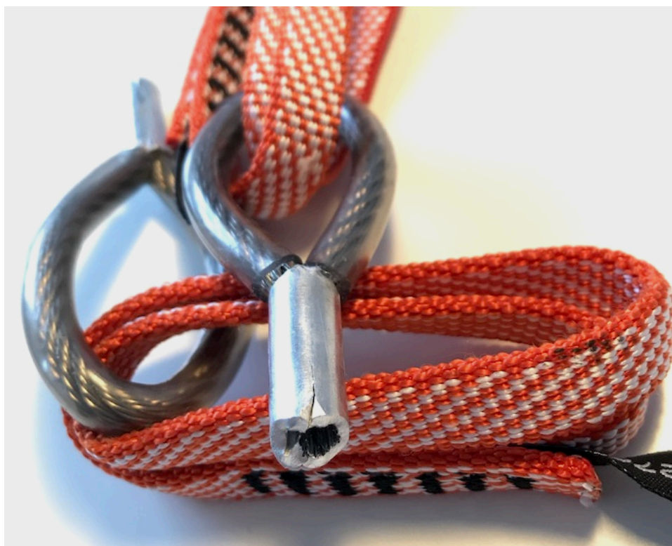
Obr.24 Hliníková objímka friendu
