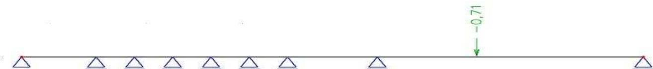
Obrázek B.3.7.5- ZS4 – Ostatní stálé zatížení od nenosné vnitřní stěny [kN] (viz str. 19)
