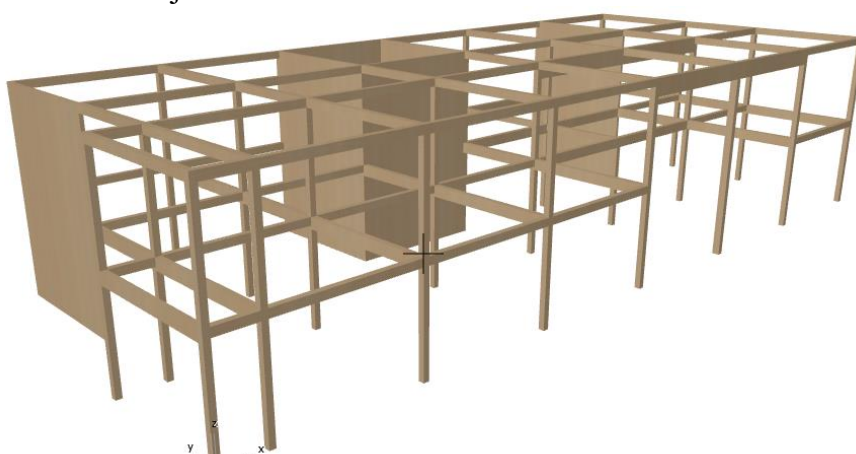
Obrázek 4 - svislé nosné konstrukce
