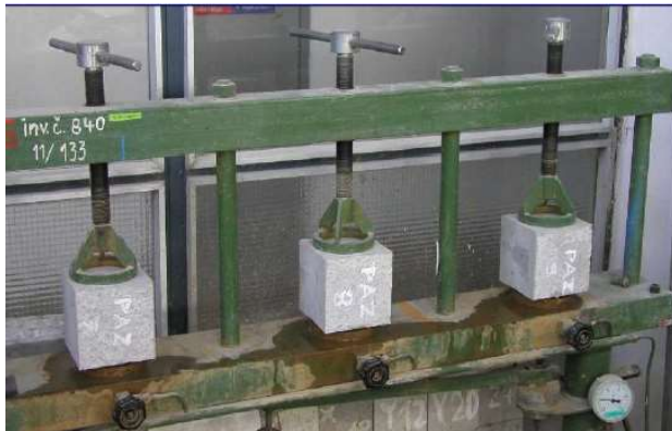
Obrázek 2: Zkušební tělesa osazená ve vodotlačné stolici | Zdroj: [2]
