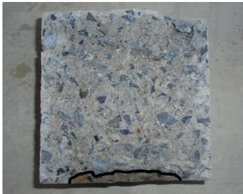
Obrázek 4: Průsak tlakové vody na zkušebním tělese | Zdroj: [1]
