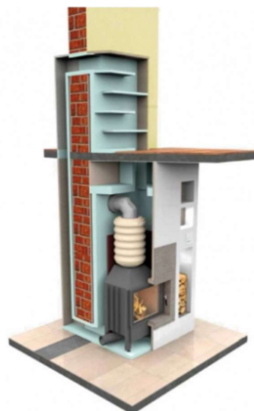
Obrázek 4.2 Příklad hypokaustního systému (zdroj: cz.brunner.eu dostupné z https://www.drevostavitel.cz/clanek/hypokaustni-system--vrchol-kamnarskeho-umeni/ )
