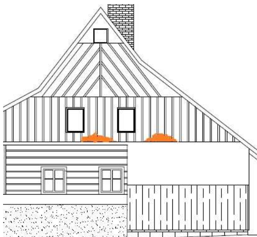
Schéma 3.9 Výskyt hniloby severovýchodním štítu
