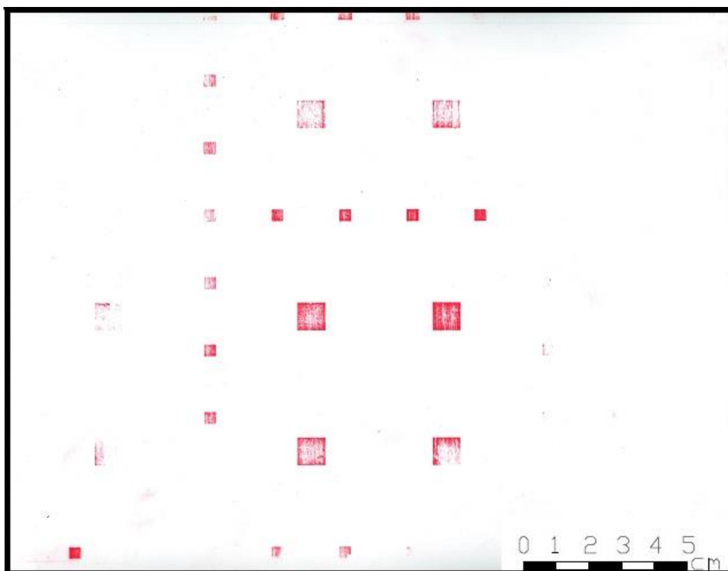
Obr. 488: Otisk z měření 22 - vzorek 2 z polymerního pražce (PU).
