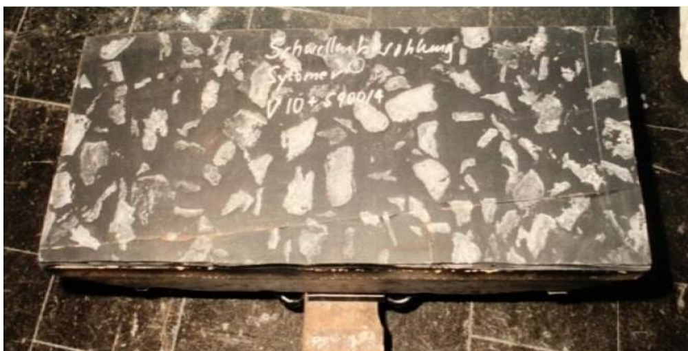
Obr. 4: Příklad metody stanovení kontaktní plochy mezi podpražcovou podložkou a kamenivem kolejového lože metodou nátěru kameniva barvou [3].
