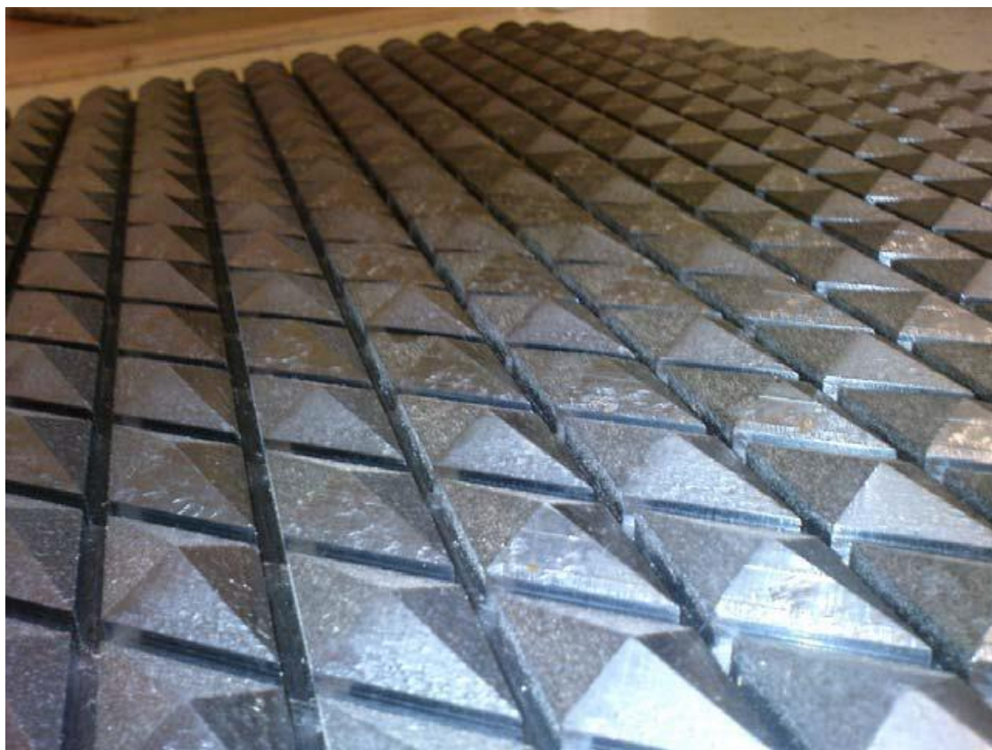
Obr. 11: Detail třetí (výsledné) zatěžovací desky [11].
