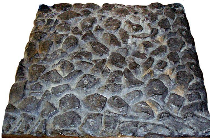
Obr. 6: Zkušební zatěžovací deska s nepravidelným reliéfem vytvořena odlitím kolejového lože (tzv. německá zatěžovací šterková deska) [11].
