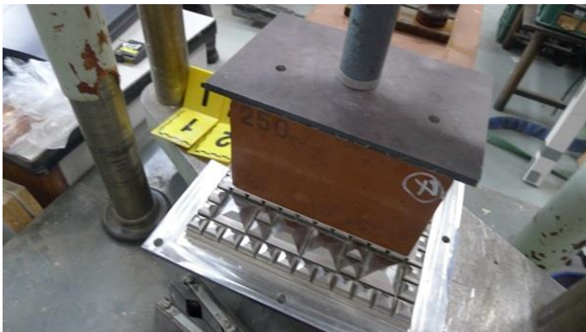
Obr. 26: Měření polymerního pražce.
