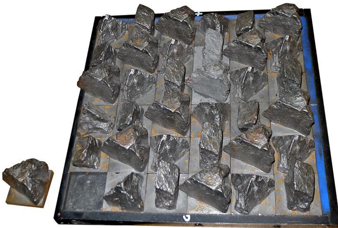
Obr. 7: Experimentální zatěžovací deska firmy Getzner Werkstoffe GmbH s možností změny povrchu vzniklá modifikací německé zatěžovací desky [11].
