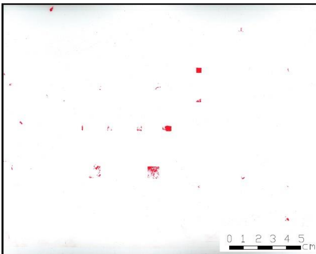
Obr. 39: Otisk z měření 13 - vzorek 1 z předpjatého betonu, který nemohl být vyhodnocován pro překročení měřicího intervalu.
