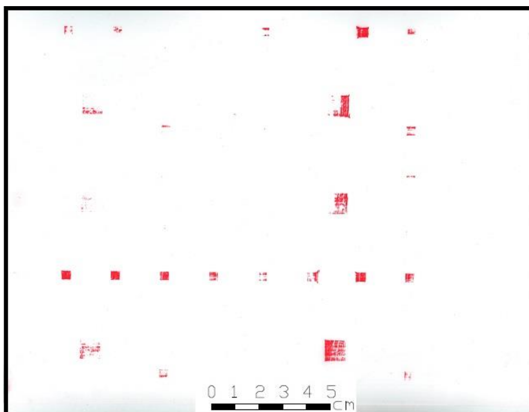
Obr. 455: Otisk z měření 19 - vzorek 2 z pražce tropického dřeva z azobe.
