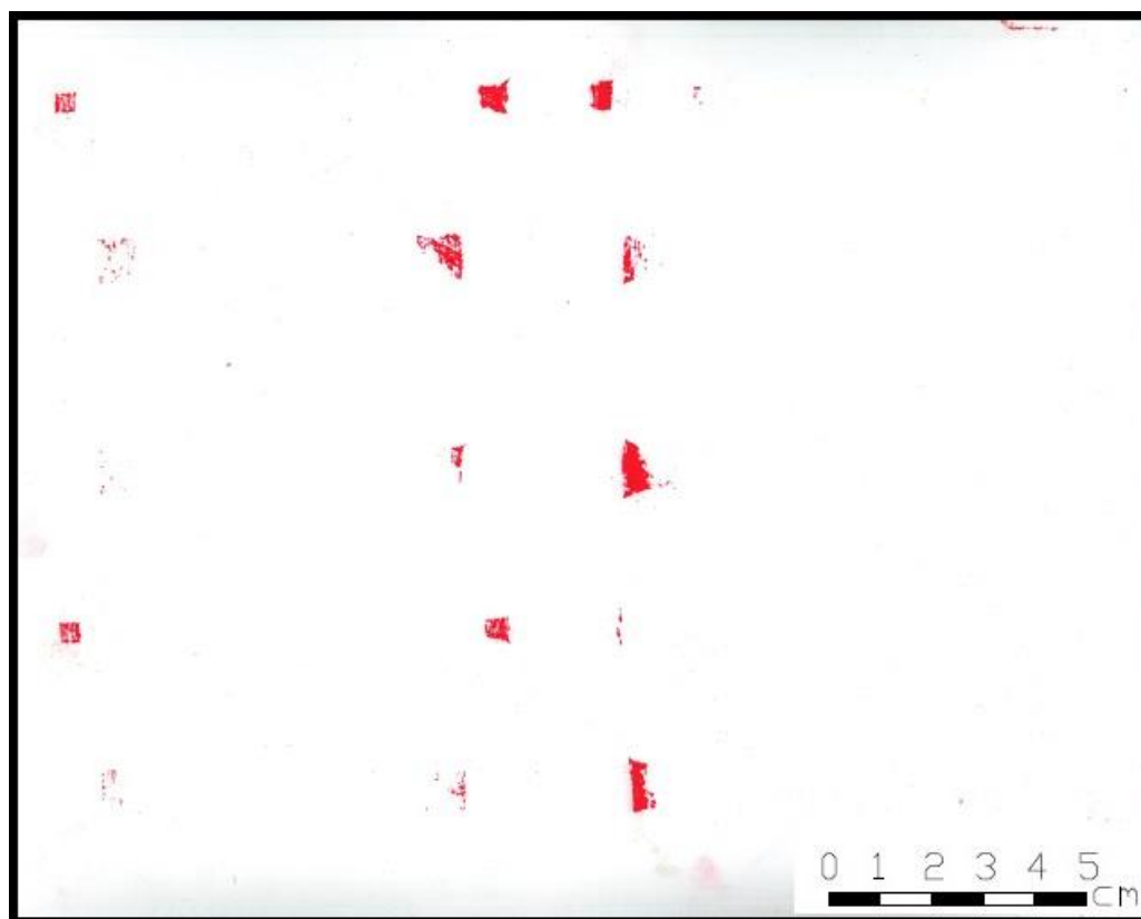
Obr. 34: Otisk z měření 7 - vzorek 3 z dubového pražce (nebylo započítáno z důvodu velké trhliny dřeva na jejichž okrajích byla kontaktní plocha s překročeným měřicím intervalem).
