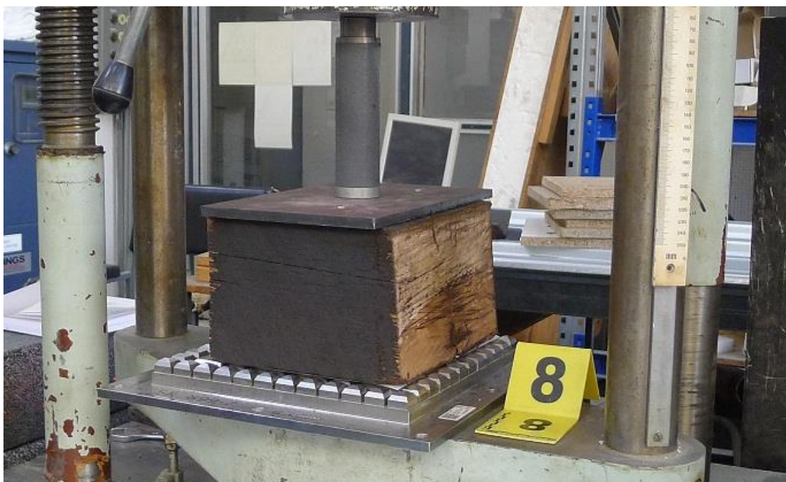
Obr. 23: Měřený vzorek dubového pražce.
