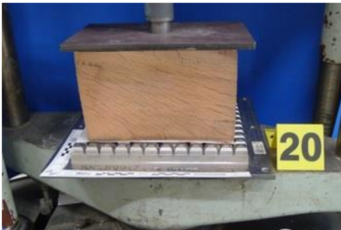
Obr. 25: Měření vzorku z tropického dřeva azobe.
