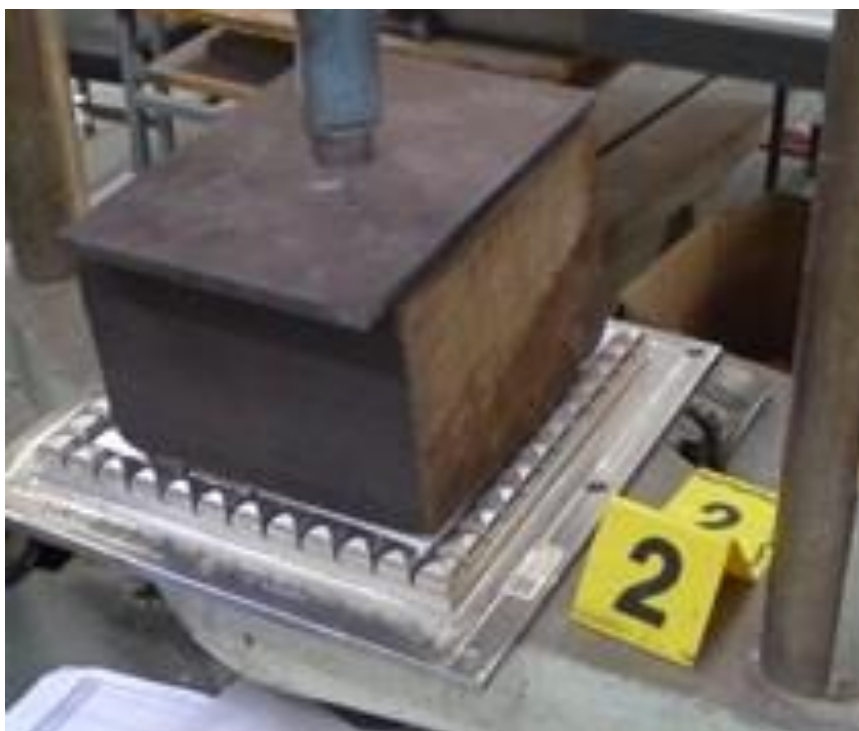
Obr. 22: Měření vzorku bukového pražce.
