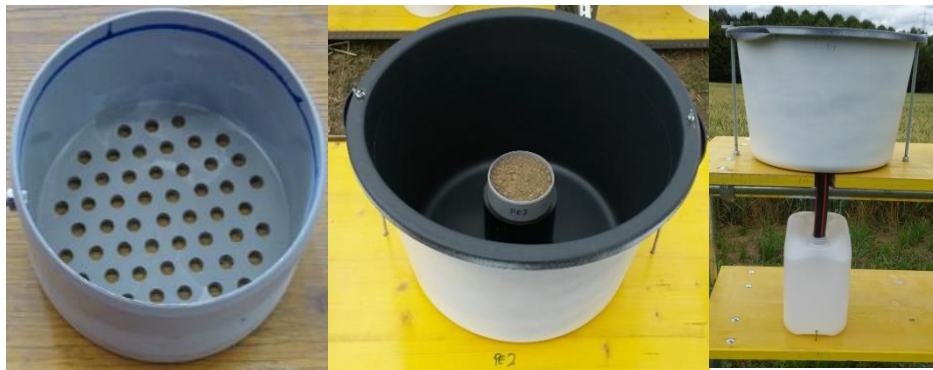
Obrázek 2: Modifikovaný "Morgan splash cup" a sběrač dešťové vody s oddělenou půdou [18]
