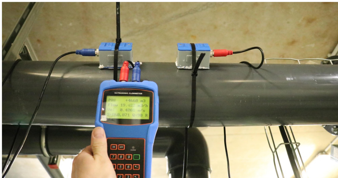
Obrázek 13. Měření ultrazvukovým průtokoměrem (foto z měření použito jako ilustrační)
