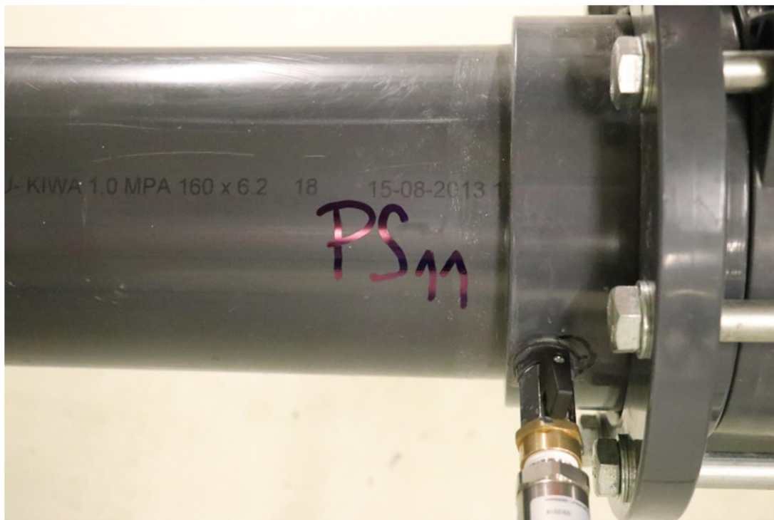
Obrázek 20. Ukázka označení bodu na potrubí
