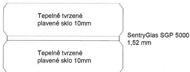
Obr. 6.2 – Příčný řez skleněnou tabulí
