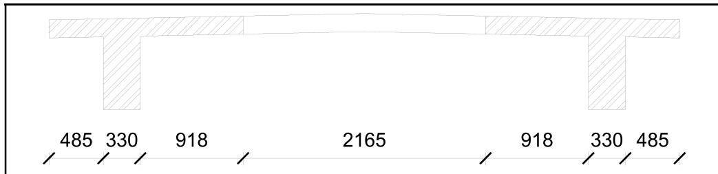
Obr. 19: Vyznačení efektivních šířek v řezu 160
