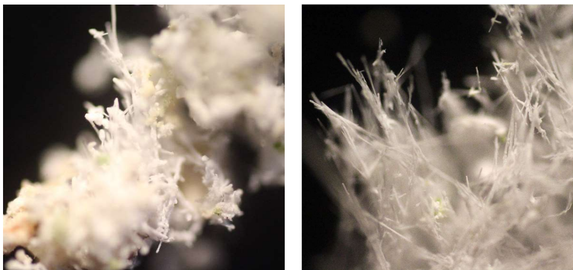
Obrázek 74: Mikroskopický snímek zkrystalizované soli do struktury jehliček
