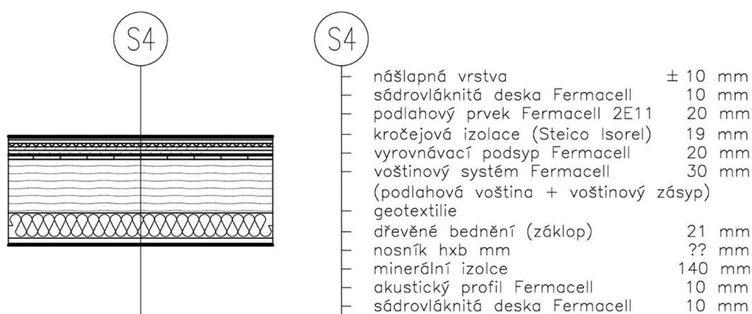
Obrázek 106: Skladba nové trémové stropní konstrukce s prvky firmy Fermacell
