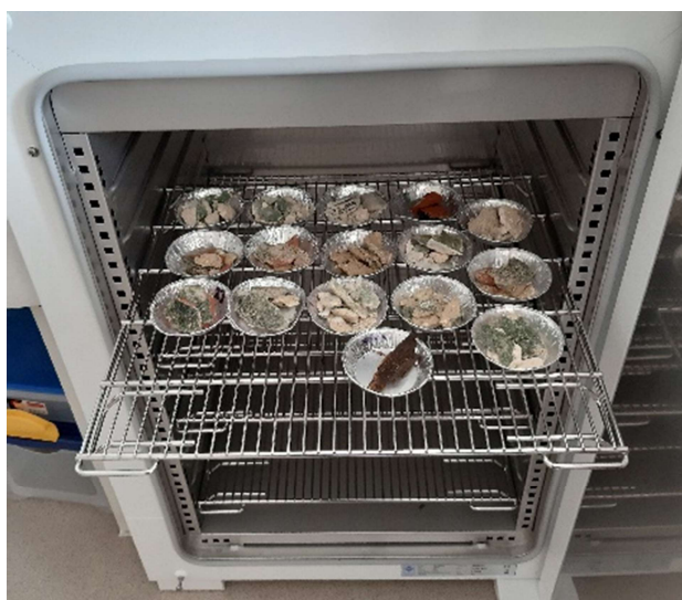
Obrázek 62: Umístění již zvažených vzorků do laboratorní sušárny
