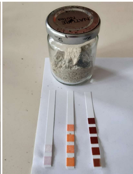
Obrázek 72: Kvalitativní analýza solí odebraného vzorku
