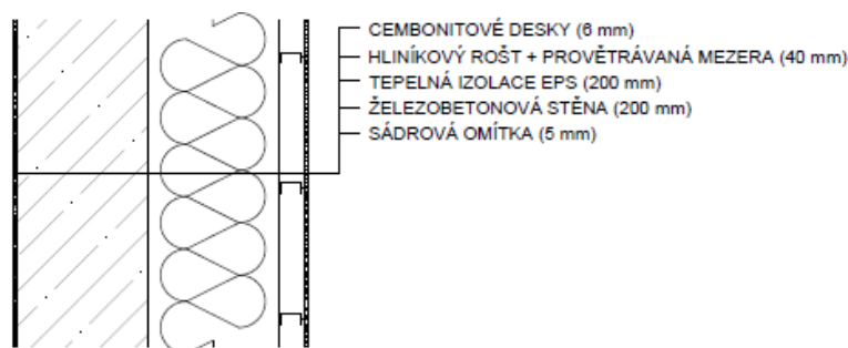
Obr. 7: Skladba železobetonové stěny s provětrávanou fasádou
