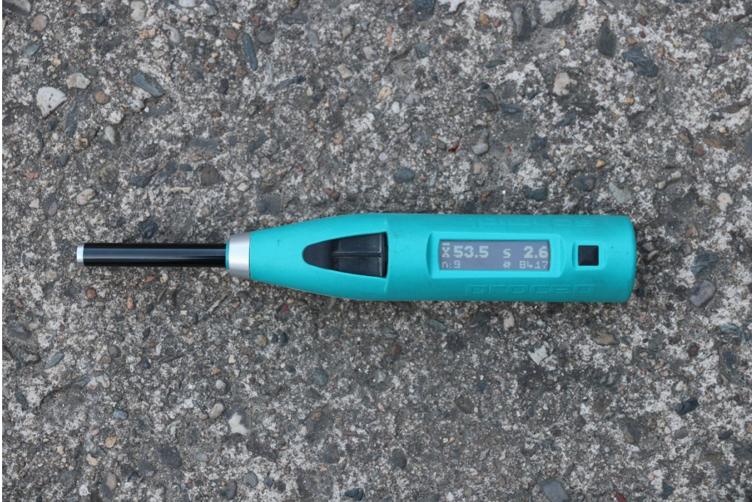
Fig. 2 Schmidt hammer Type L (picture: M. Jonáš)
